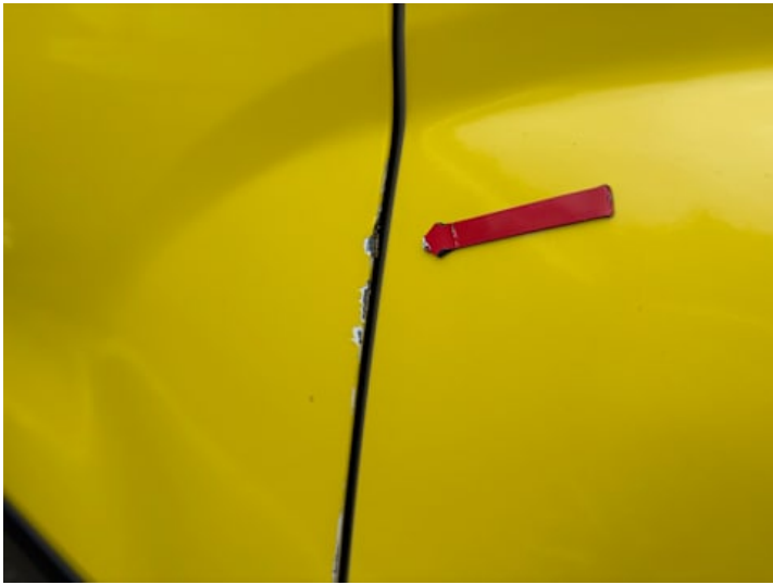
Türe hinten links (Lackschaden)
