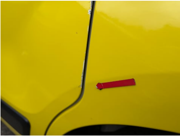
Türe hinten links (Lackschaden)
