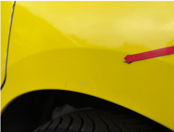
Seitenteil hinten links (Lackschaden)
