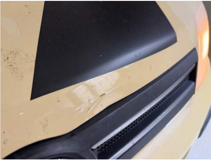
Motorhaube (Lackschaden, Delle)
