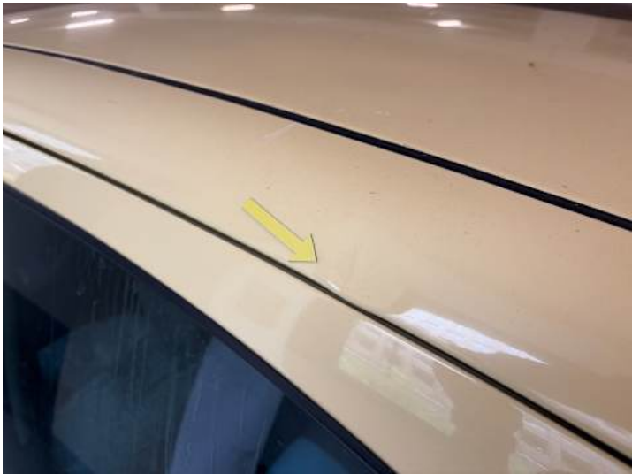
Dach (Delle, Lackschaden)
