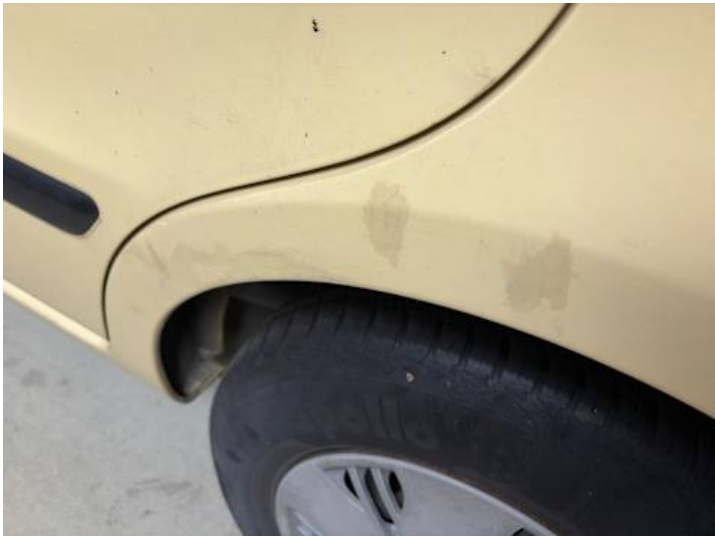
Seitenteil hinten links (Lackschaden)
