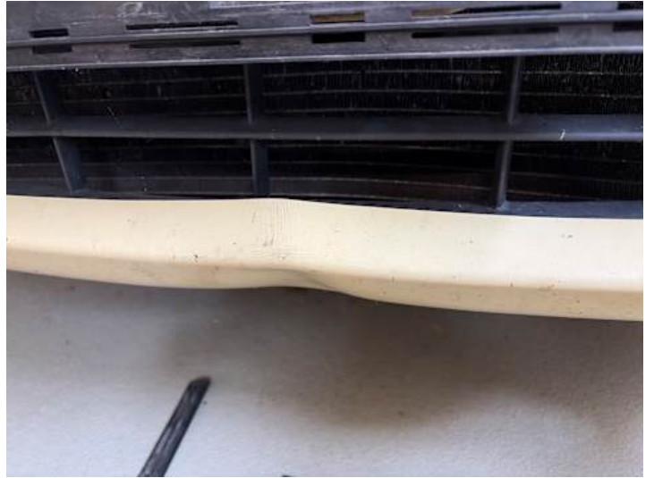
Stoßstange vorne (Lackschaden, Spaltmaße ungenau, Riss/Bruch, Verformung)
