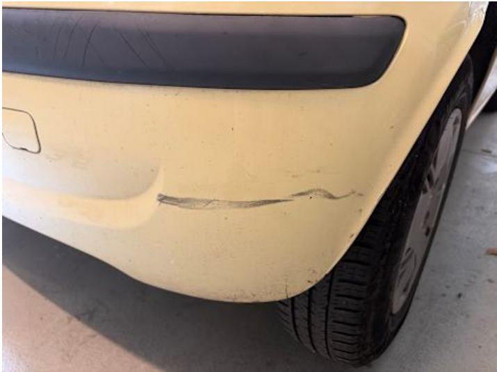
Stoßstange hinten (Kratzer, Lackschaden)
