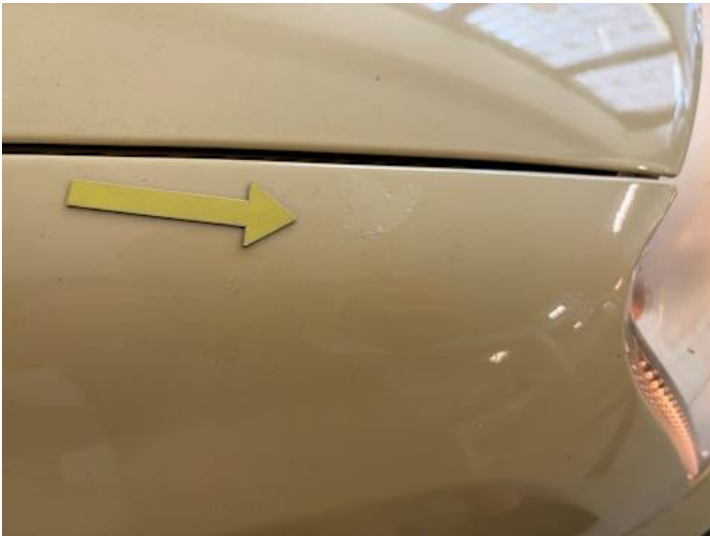
Kotflügel vorne rechts (Lackschaden)
