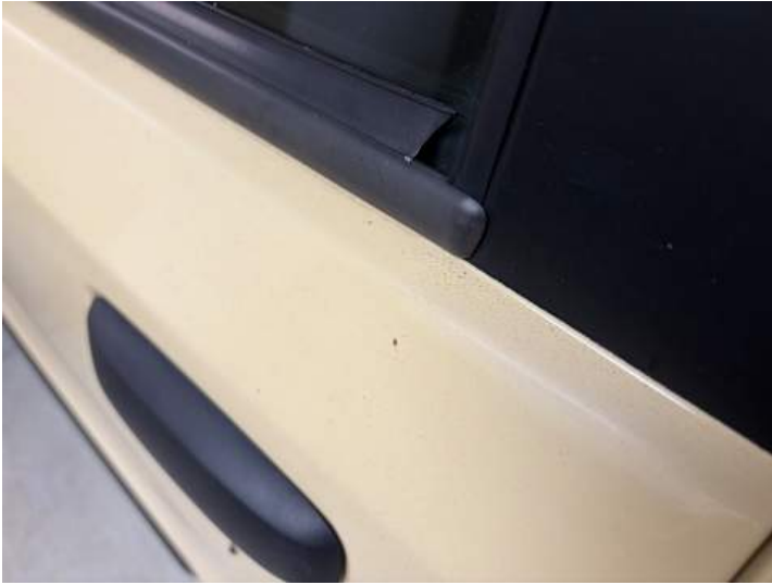
Türe hinten links (Lackschaden, Riss/Bruch)
