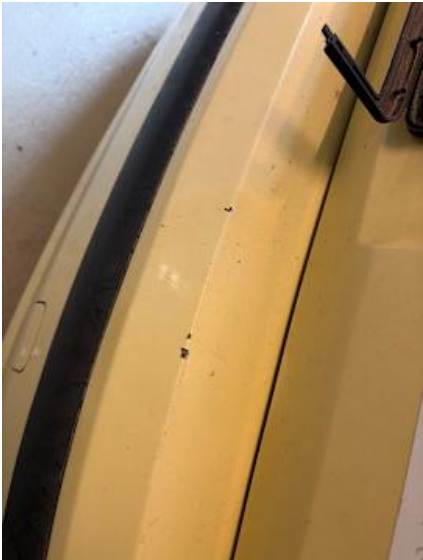
Stoßstange hinten (Kratzer, Lackschaden)
