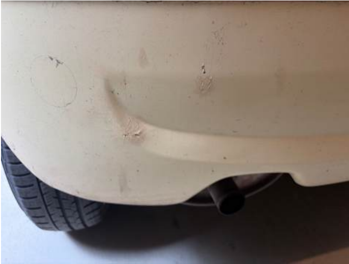
Stoßstange hinten (Kratzer, Lackschaden)
