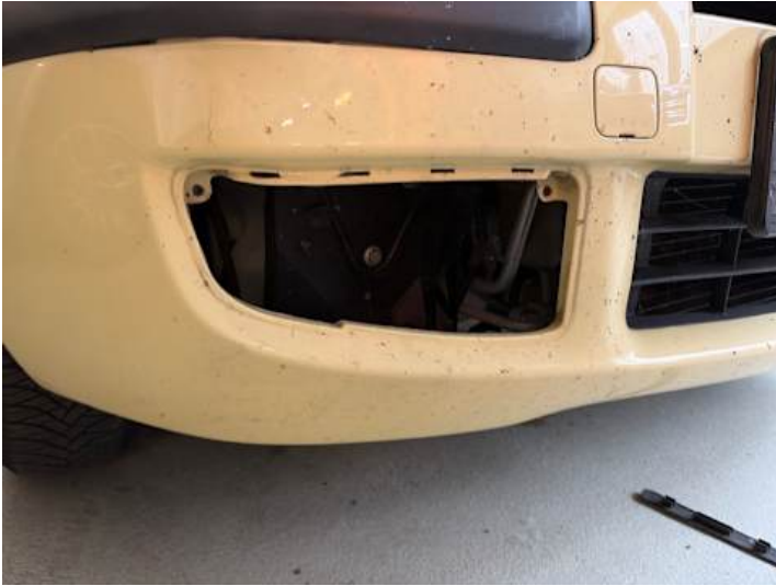
Stoßstange vorne (Lackschaden, Spaltmaße ungenau, Riss/Bruch, Verformung)
