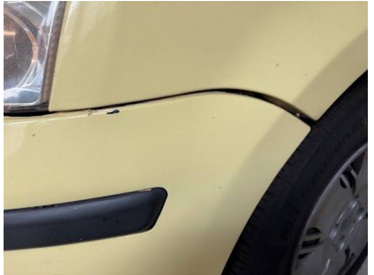
Stoßstange vorne (Lackschaden, Spaltmaße ungenau, Riss/Bruch, Verformung)
