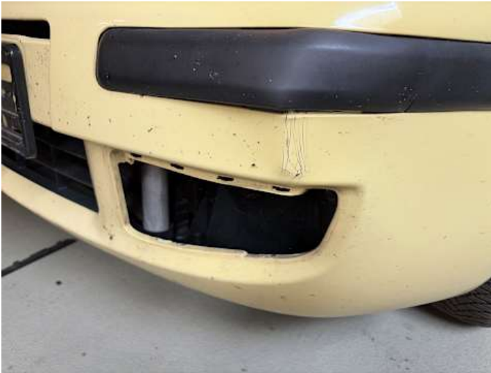
Stoßstange vorne (Lackschaden, Spaltmaße ungenau, Riss/Bruch, Verformung)
