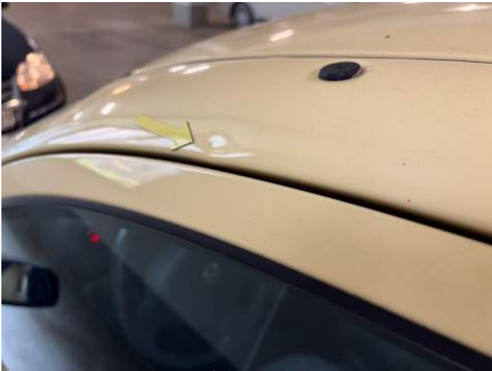
Dach (Delle, Lackschaden)
