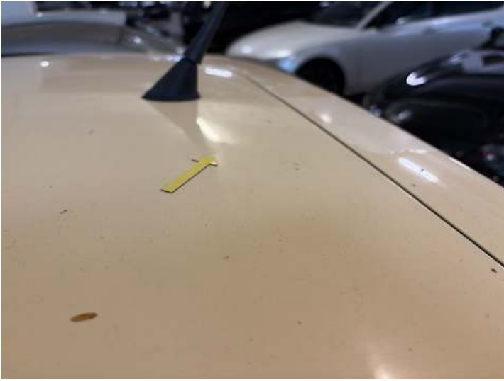
Dach (Delle, Lackschaden)
