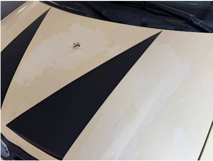
Motorhaube (Lackschaden, Delle)
