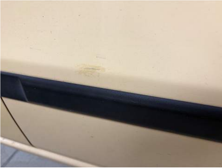
Türe hinten links (Lackschaden, Riss/Bruch)
