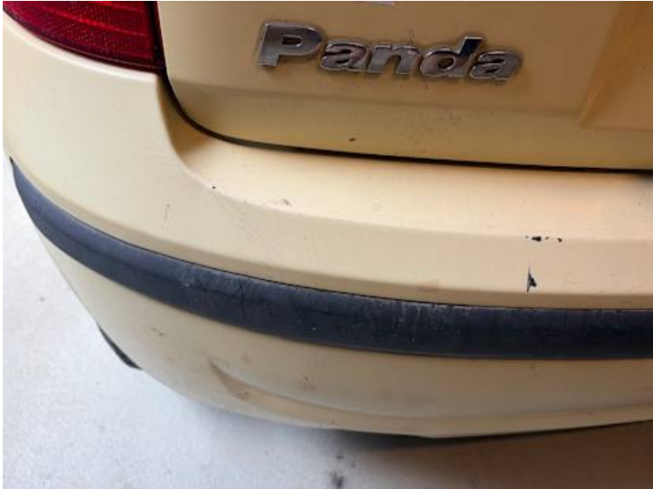
Stoßstange hinten (Kratzer, Lackschaden)
