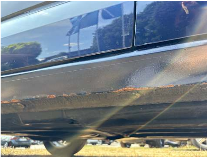
Schweller rechts (Rost, Ausgeblichen/Matt)
