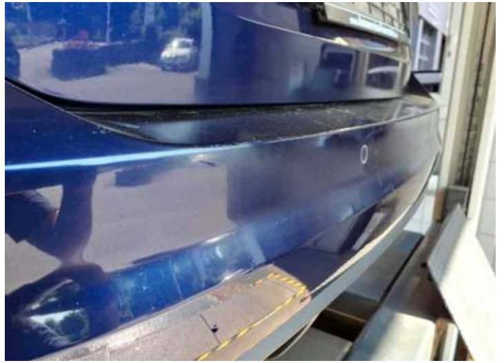
Stoßstange hinten (Unsachgemäß instand gesetzt)
