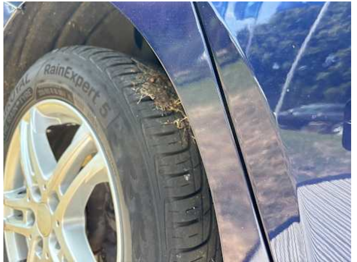
Seitenteil hinten rechts (Unsachgemäß instand gesetzt)
