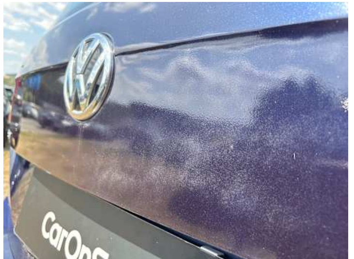
Heckklappe (Unsachgemäß instand gesetzt)
