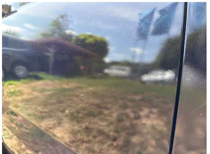
Türe hinten rechts (Unsachgemäß instand gesetzt)
