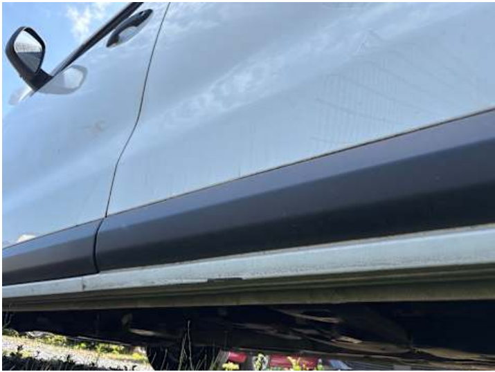
Schweller links (Delle, Kratzer)
