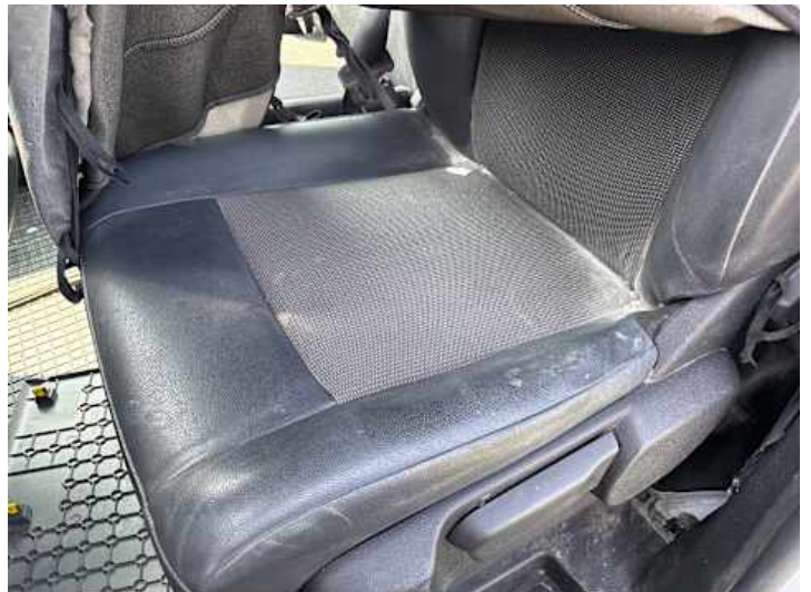
Innenraum (Verschmutzung, Verschleiß)
