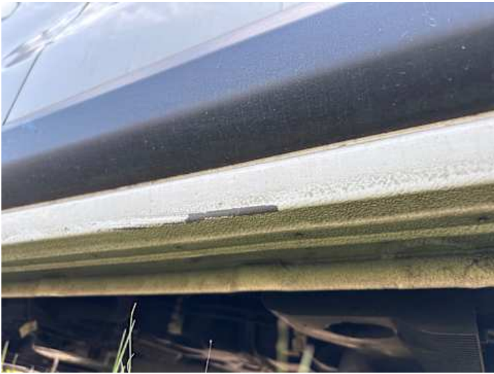
Schweller links (Delle, Kratzer)
