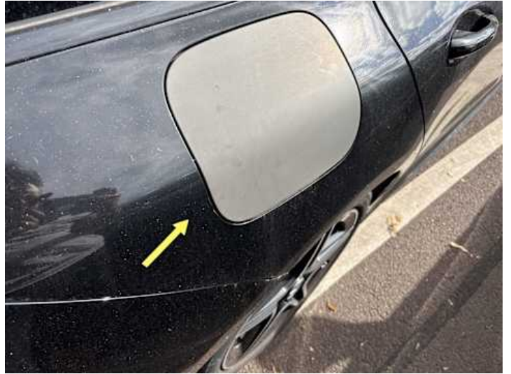
Seitenteil hinten rechts (Anderer Schaden): Tankdeckel Lack unterschied
