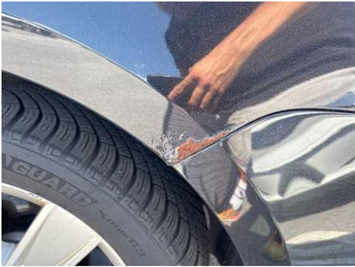
Seitenteil hinten links (Rost)
