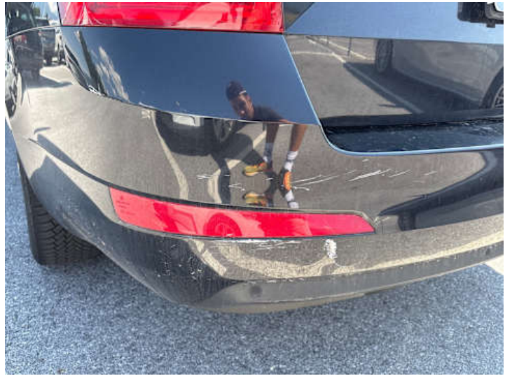
Stoßstange hinten (Kratzer, Riss/Bruch)
