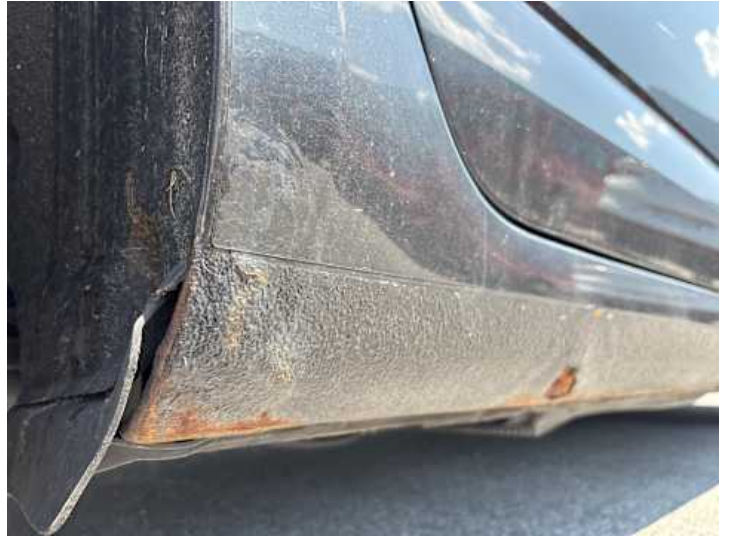
Schweller rechts (Rost)
