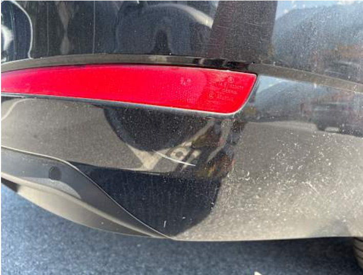
Stoßstange hinten (Kratzer, Riss/Bruch)
