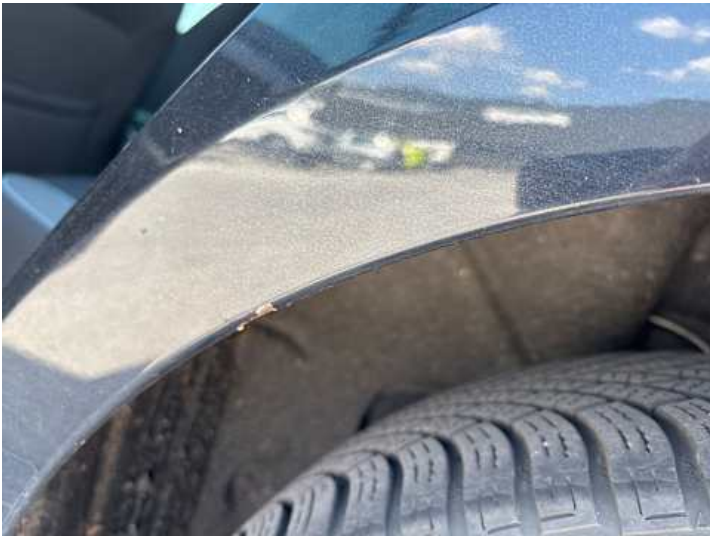
Seitenteil hinten links (Rost)
