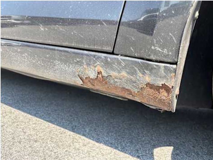
Schweller rechts (Rost)
