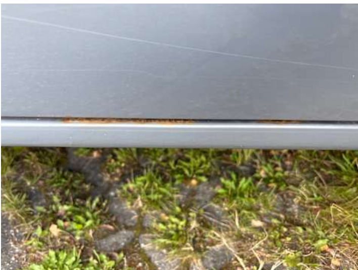
Schweller rechts (Rost)
