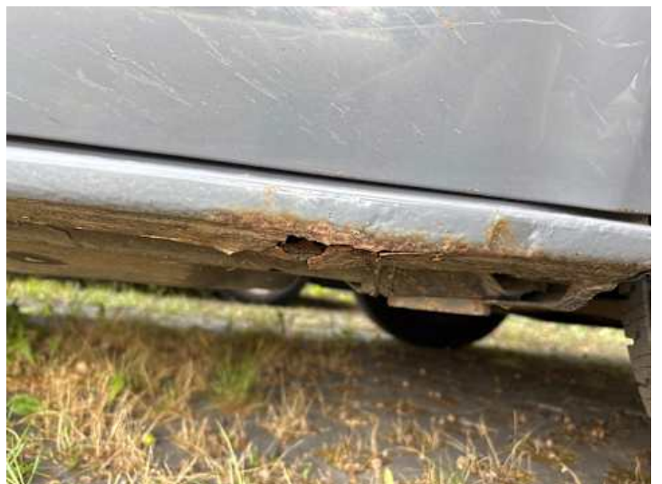
Schweller rechts (Rost)
