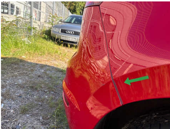
Stoßstange hinten (Spaltmaße ungenau)
