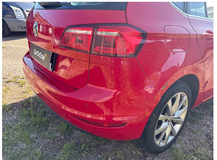
Stoßstange hinten (Spaltmaße ungenau)
