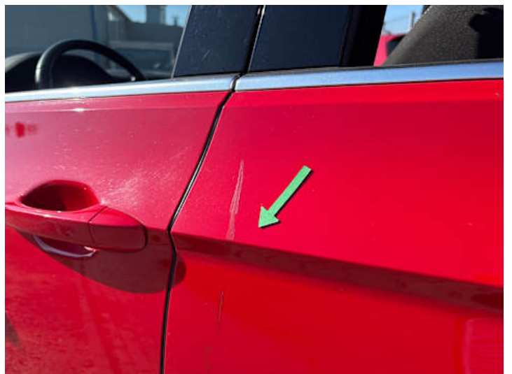
Türe hinten links (Kratzer)
