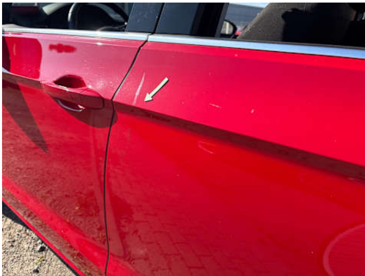
Türe hinten links (Kratzer)
