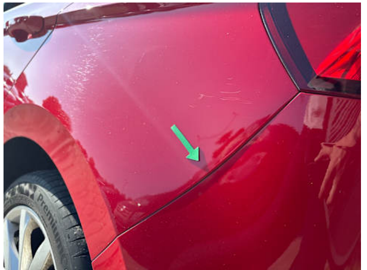
Stoßstange hinten (Spaltmaße ungenau)
