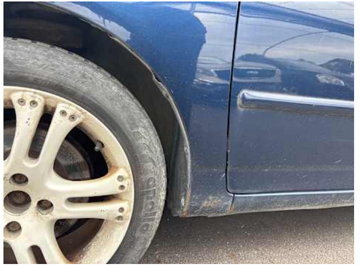
Kotflügel vorne links (Rost)
