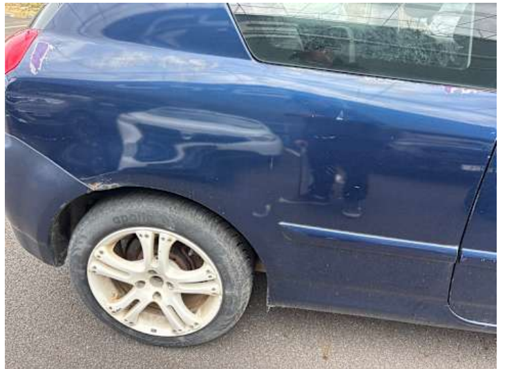
Seitenteil hinten rechts (Rost, Lackschaden, Delle)
