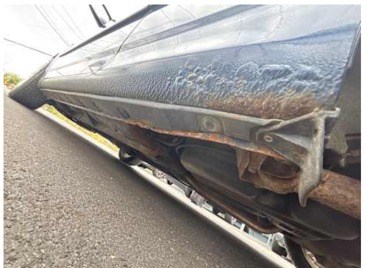
Schweller links (Rost)
