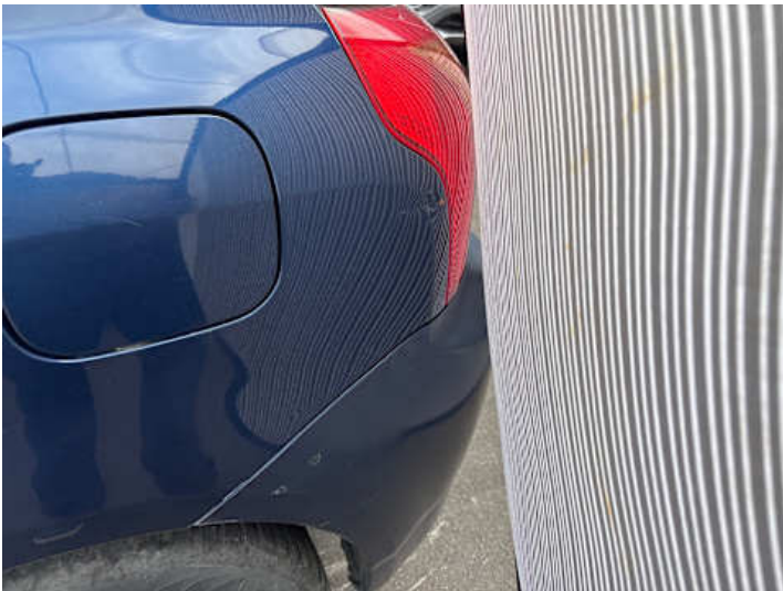
Seitenteil hinten links (Delle, Rost)
