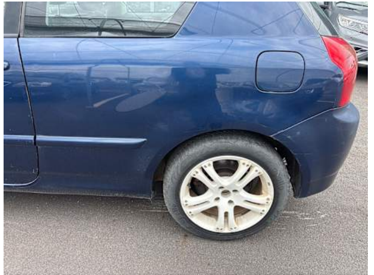
Seitenteil hinten links (Delle, Rost)
