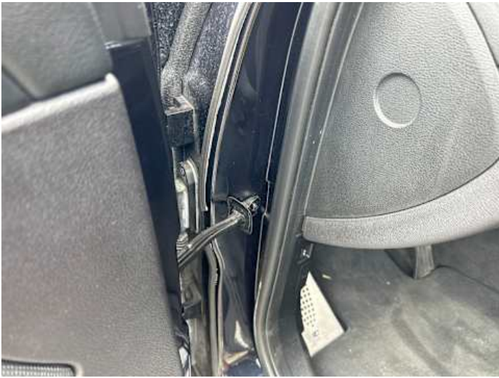
Innenraum (Anderer Schaden): Beklebt mit zusätzlicher Dichtung.
