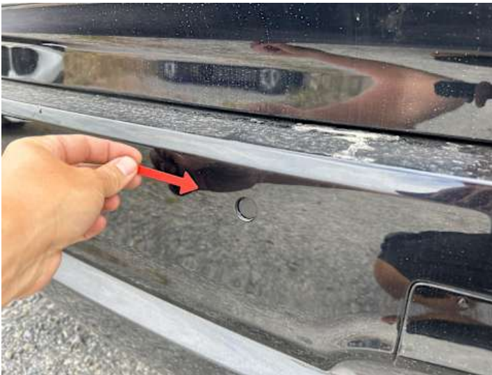
Stoßstange hinten (Anderer Schaden): Parksensor eingedrückt
