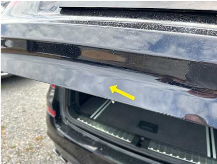
Heckklappe (Kratzer, Unsachgemäß instand gesetzt)
