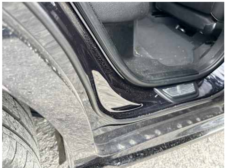
Innenraum (Anderer Schaden): Beklebt mit zusätzlicher Dichtung.
