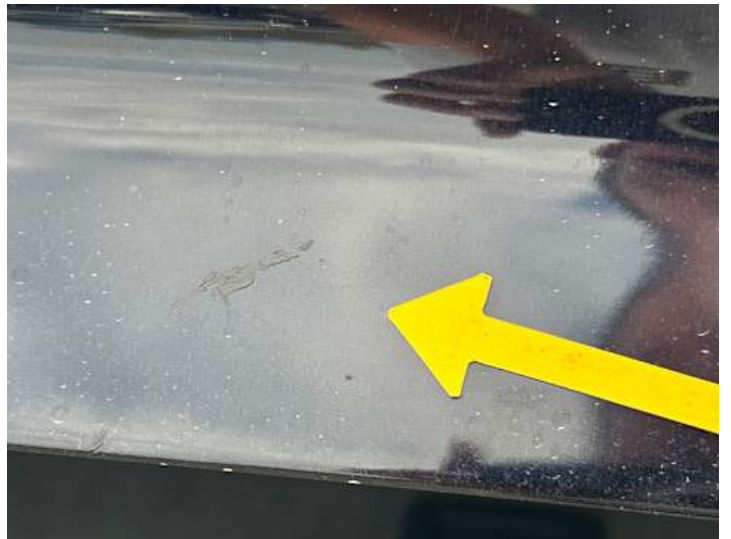
Heckklappe (Kratzer, Unsachgemäß instand gesetzt)
