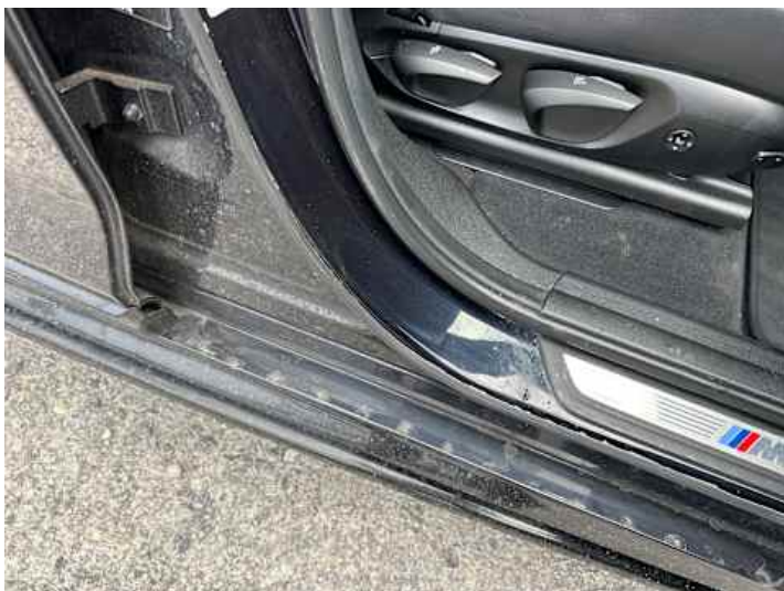
Innenraum (Anderer Schaden): Beklebt mit zusätzlicher Dichtung.
