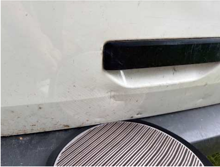
Heckklappe (Delle, Verformung)
