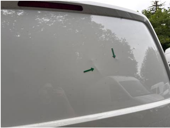
Heckklappe (Delle, Verformung)
