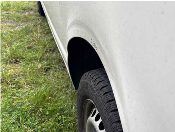
Seitenteil hinten links (Kratzer, Lackschaden, Verformung)
