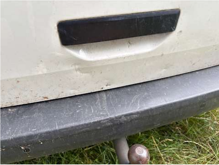
Heckklappe (Delle, Verformung)
