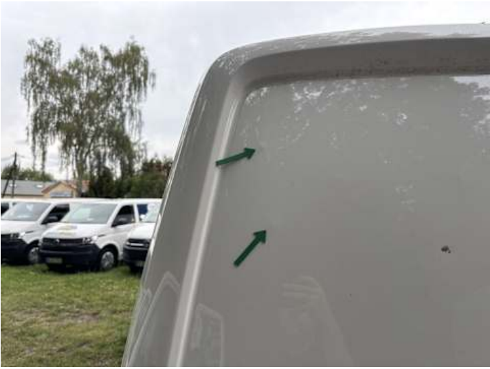
Heckklappe (Delle, Verformung)
