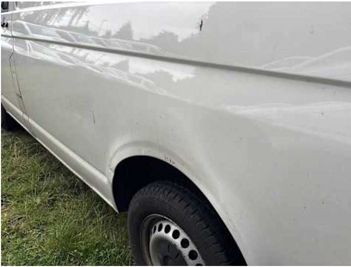
Seitenteil hinten links (Kratzer, Lackschaden, Verformung)
