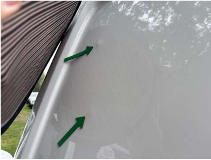
Heckklappe (Delle, Verformung)
