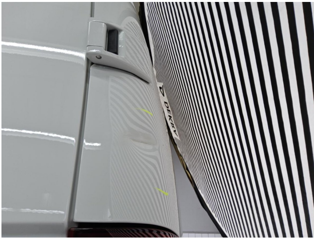
Flügeltür links Deformiert
