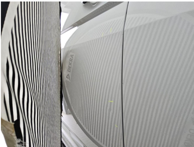
Tür hinten rechts - Delle entfernen
