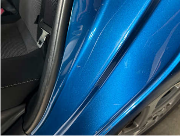
Schweller links (Kratzer, Delle)
