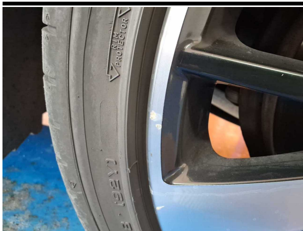
Beschädigung #4: Rad/Reifen: Leichtmetallfelge vorn rechts - Kratzer - Wertminderung
