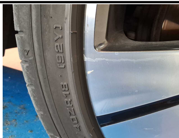
Beschädigung #4: Rad/Reifen: Leichtmetallfelge vorn rechts - Kratzer - Wertminderung
