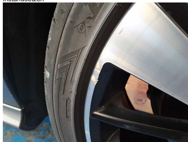
Beschädigung #4: Rad/Reifen: Leichtmetallfelge vorn rechts - Kratzer - Wertminderung
