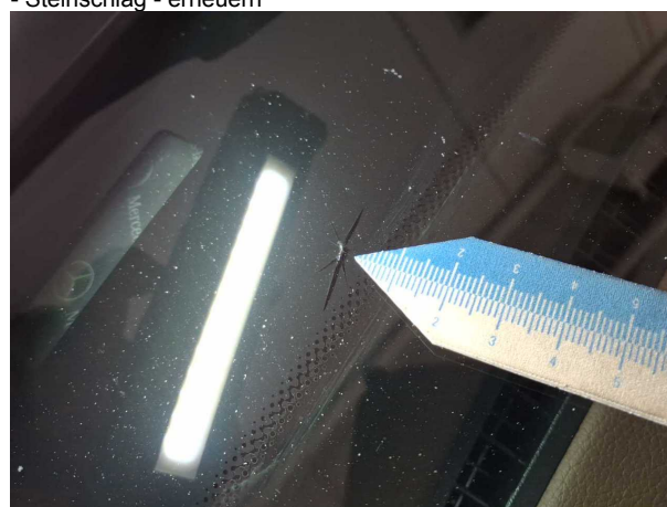
Beschädigung #9: Verglasung: Frontscheibe (Mit Rissbildung) - Steinschlag - erneuern
