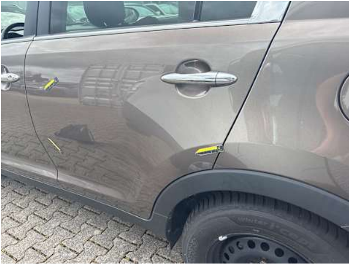
Türe hinten links (Delle, Kratzer)
