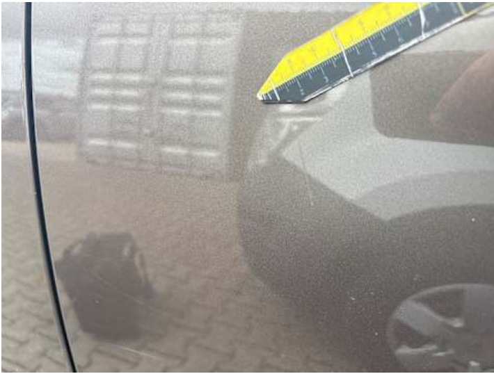
Türe hinten links (Kratzer)
