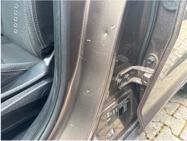
Schweller links (Lackschaden, Delle)
