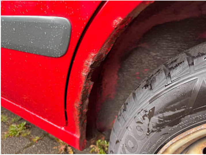
Seitenteil hinten links (Rost)
