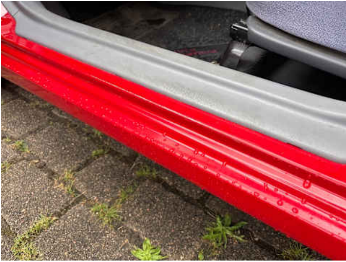
Schweller links (Kratzer)
