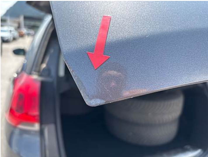
Heckklappe (Rost, Lackschaden)
