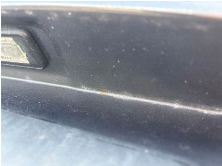
Heckklappe (Rost, Lackschaden)
