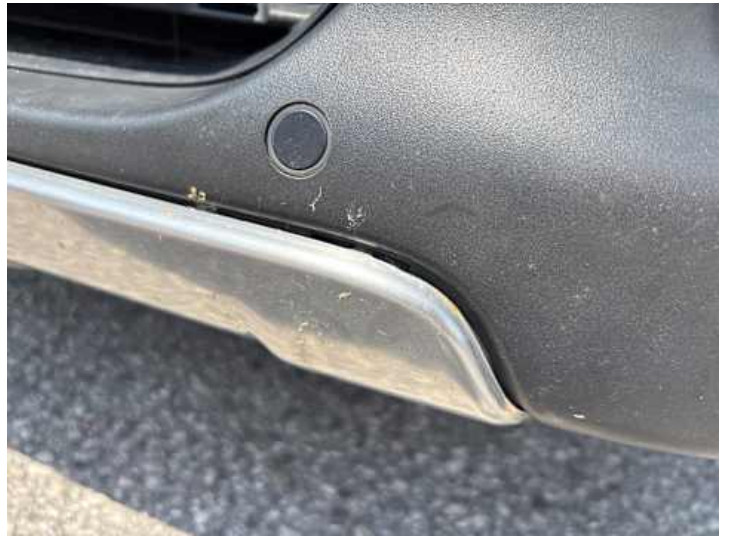
Stoßstange vorne (Steinschlag, Spaltmaße ungenau)
