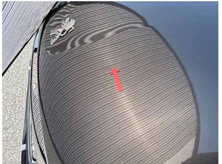
Motorhaube (Delle, Lackschaden)
