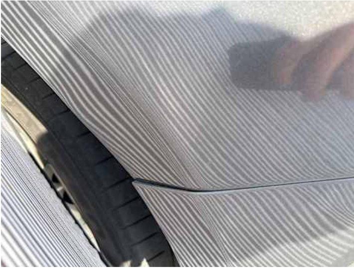
Kotflügel vorne rechts (Verformung, Spaltmaße ungenau)
