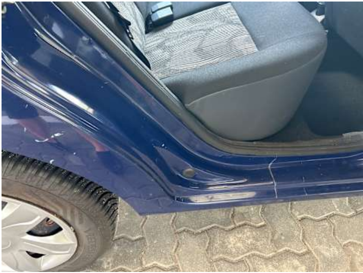
Schweller rechts (Kratzer)
