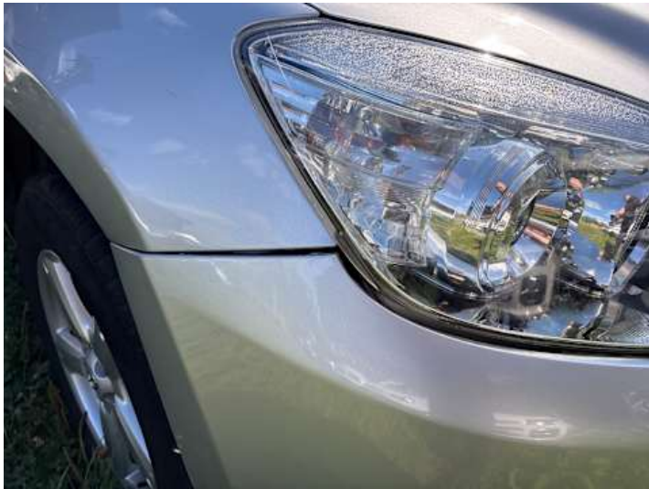
Stoßstange vorne (Kratzer, Spaltmaße ungenau, Lackschaden)
