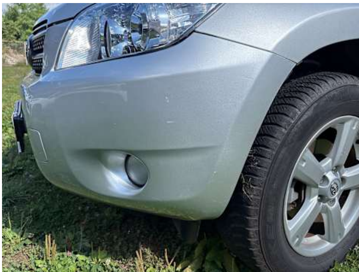
Stoßstange vorne (Kratzer, Spaltmaße ungenau, Lackschaden)
