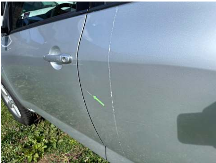
Türe hinten links (Kratzer, Delle)
