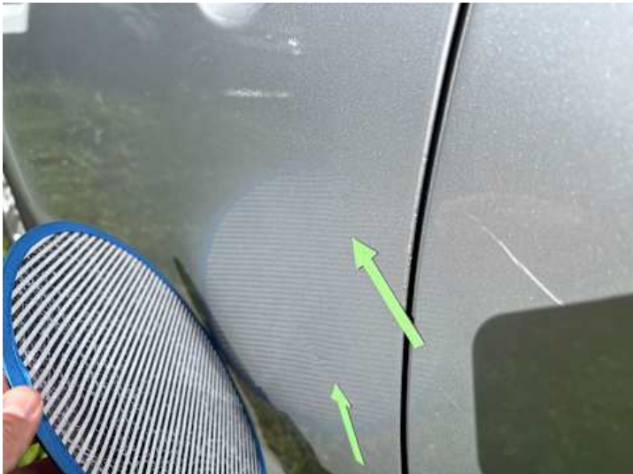
Fahrtür (Kratzer, Delle)
