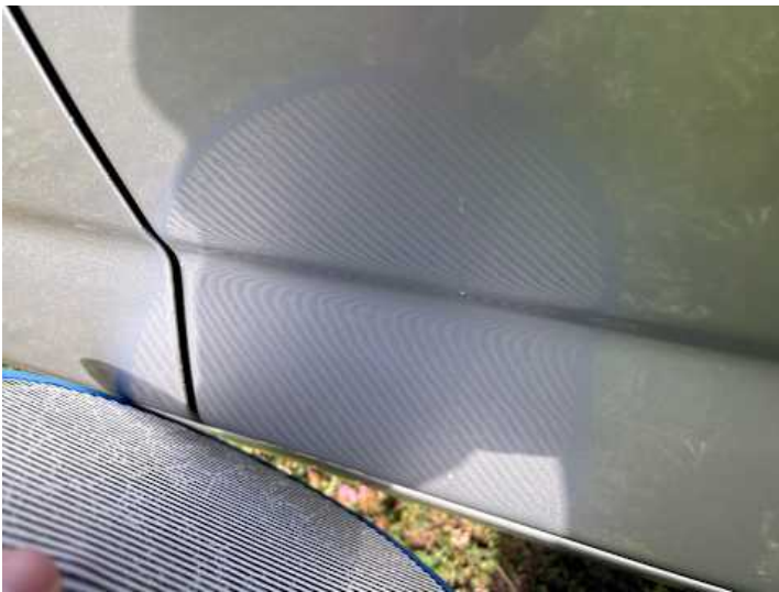
Türe hinten links (Kratzer, Delle)
