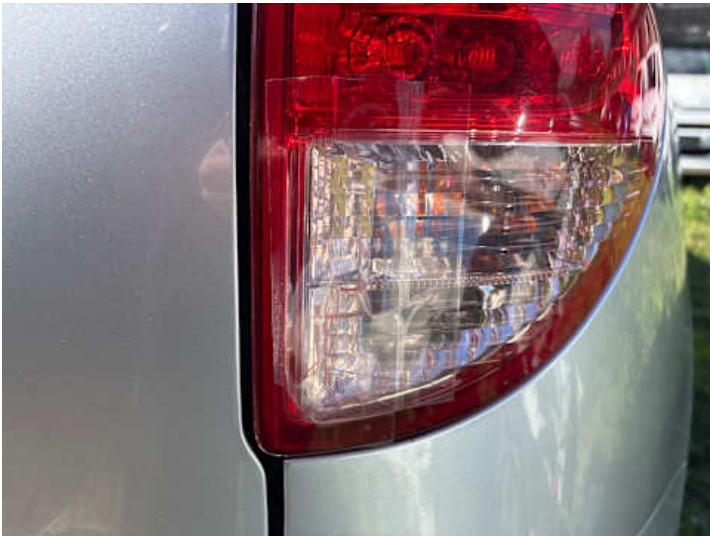
Rücklicht (rechts) (Riss/Bruch)
