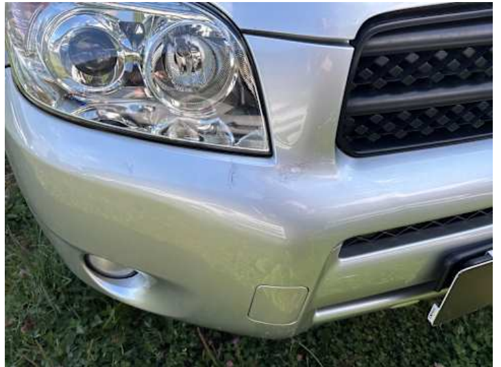
Stoßstange vorne (Kratzer, Spaltmaße ungenau, Lackschaden)
