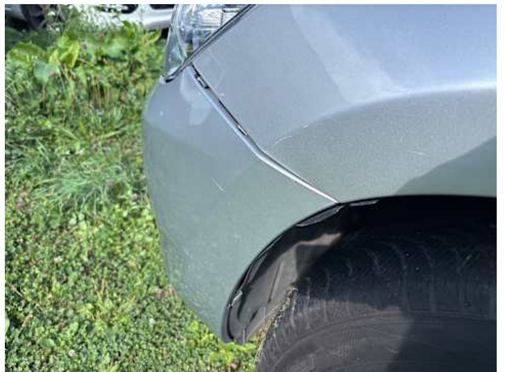
Stoßstange vorne (Kratzer, Spaltmaße ungenau, Lackschaden)
