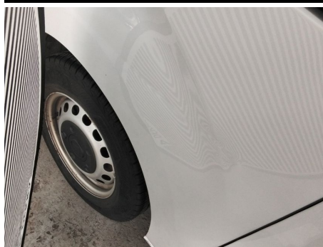
Seitenwand / Hinten Rechts / Delle
