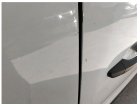
Tür / Vorne Rechts / Kratzer
