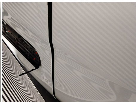
Heckklappe / Kofferraumtür / Hinten Rechts / Delle
