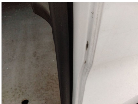
Heckklappe / Kofferraumtür / Hinten Rechts / Delle
