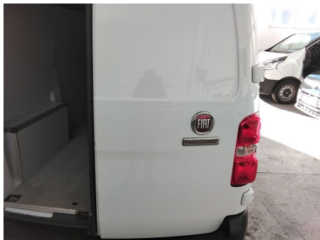
Heckklappe / Kofferraumtür / Hinten Rechts / Delle
