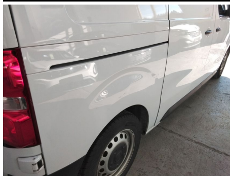
Seitenwand / Hinten Rechts / Delle
