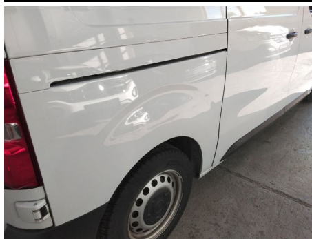
Seitenwand / Hinten Rechts / Delle
