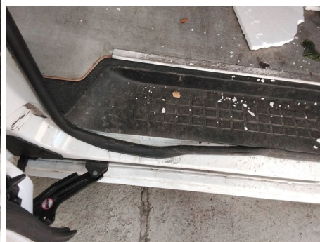
Türeinstieg / Rechts / Delle
