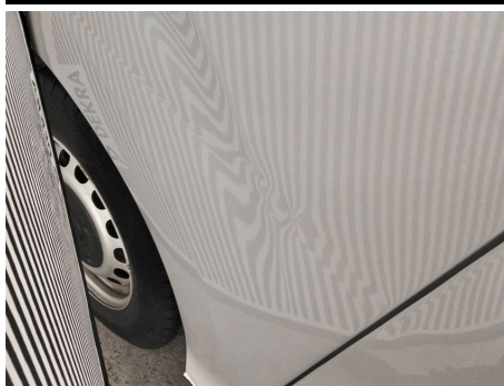
Seitenwand / Hinten Rechts / Delle
