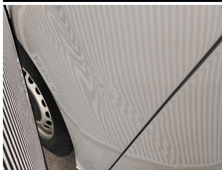
Seitenwand / Hinten Rechts / Delle
