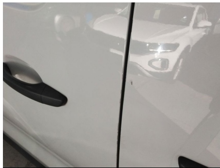
Tür / Rechts / Delle
