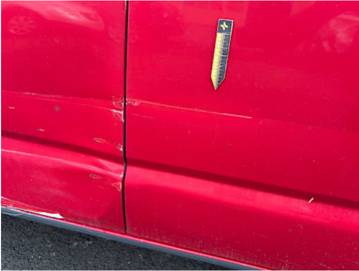
Beifahrertür (Kratzer, Verformung)
