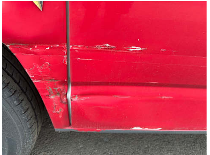
Türe hinten rechts (Kratzer, Verformung)
