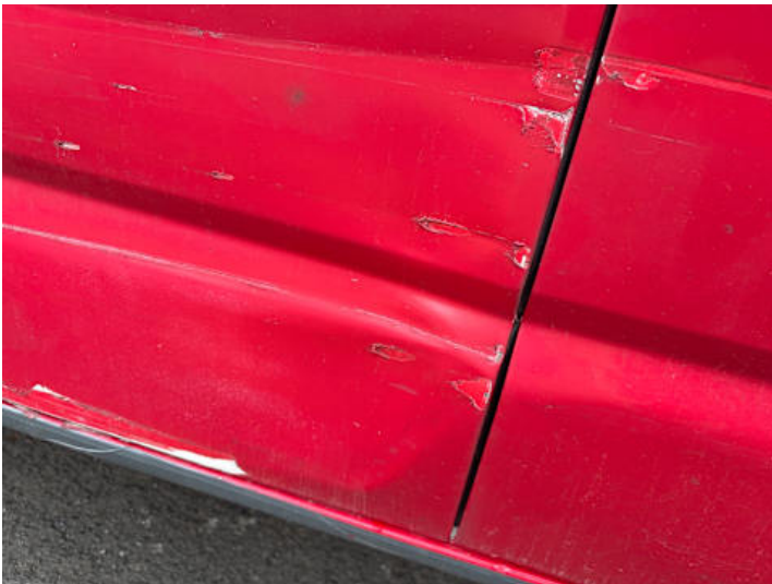
Türe hinten rechts (Kratzer, Verformung)
