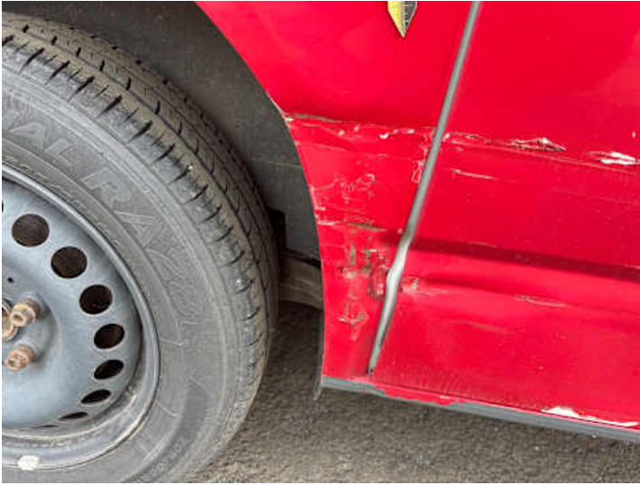
Seitenteil hinten rechts (Kratzer, Verformung)
