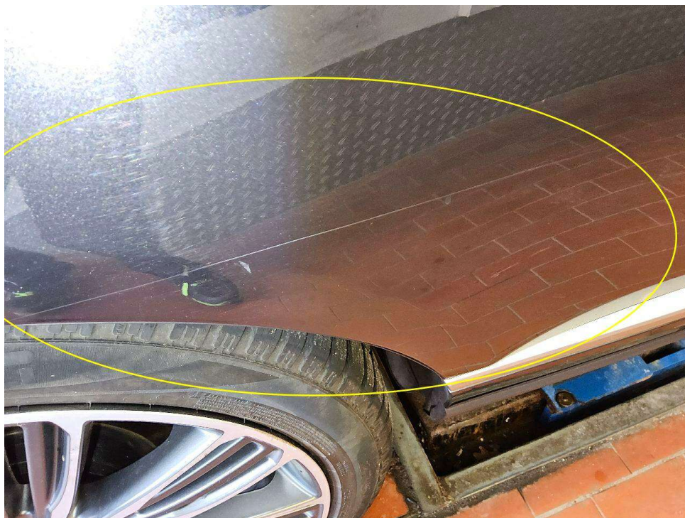
Bild 9 : Tür hinten rechts verkratzt und eingedellt
