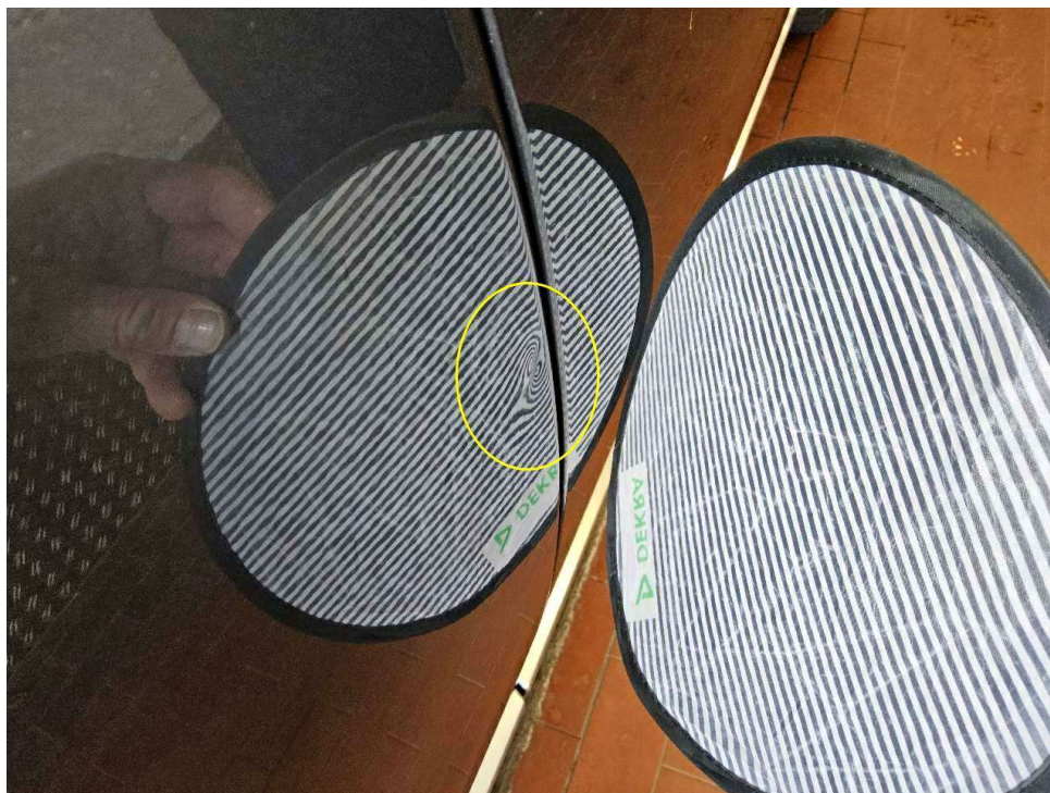
Bild 11 : Tür hinten rechts verkratzt und eingedellt
