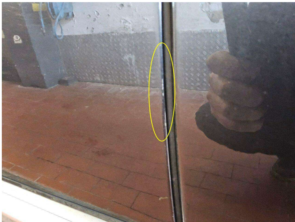
Bild 15 : Tür vorne links, Türkante Lackabplatzer
