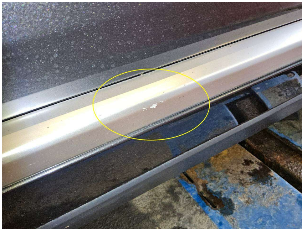
Bild 16 : Tür vorne links, Türblende verschrammt
