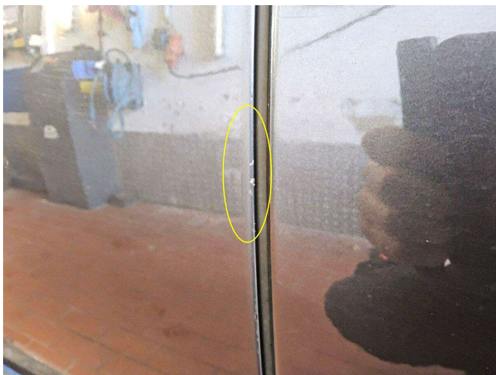
Bild 14 : Tür vorne links, Türkante Lackabplatzer
