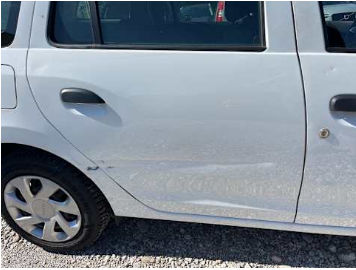
Türe hinten rechts (Verformung, Kratzer, Lackschaden)
