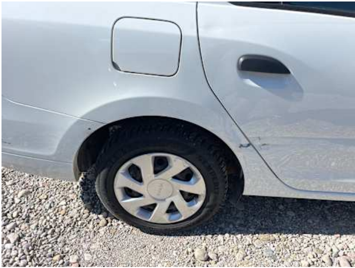
Seitenteil hinten rechts (Kratzer, Lackschaden, Verformung)
