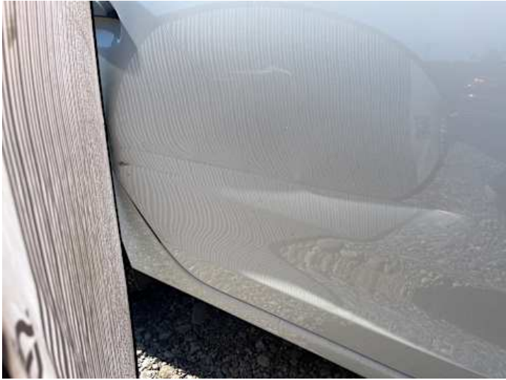
Türe hinten rechts (Verformung, Kratzer, Lackschaden)
