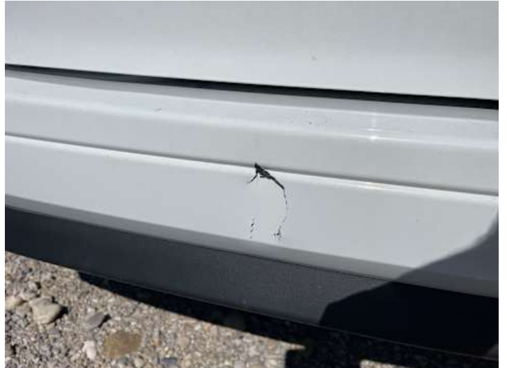
Stoßstange hinten (Kratzer, Lackschaden, Riss/Bruch)
