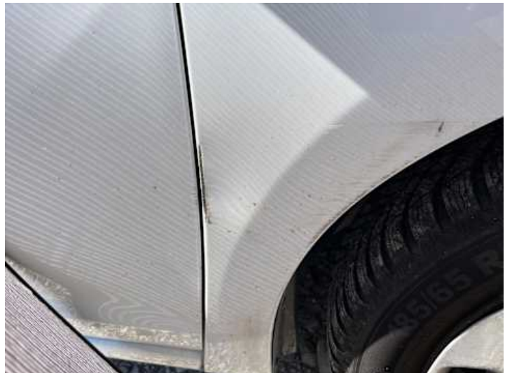
Kotflügel vorne rechts (Verformung, Kratzer, Lackschaden)
