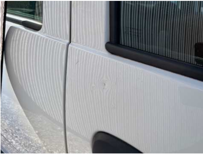
Beifahrertür (Kratzer, Lackschaden, Delle)
