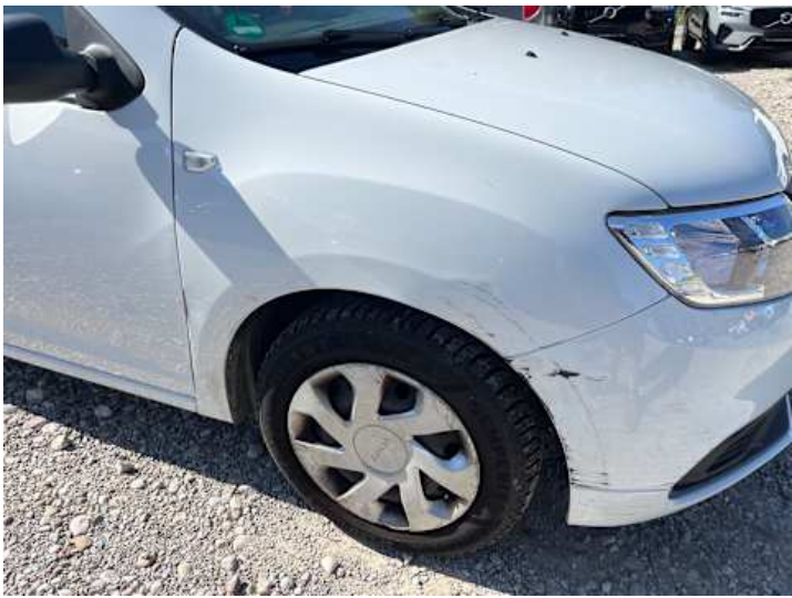
Kotflügel vorne rechts (Verformung, Kratzer, Lackschaden)
