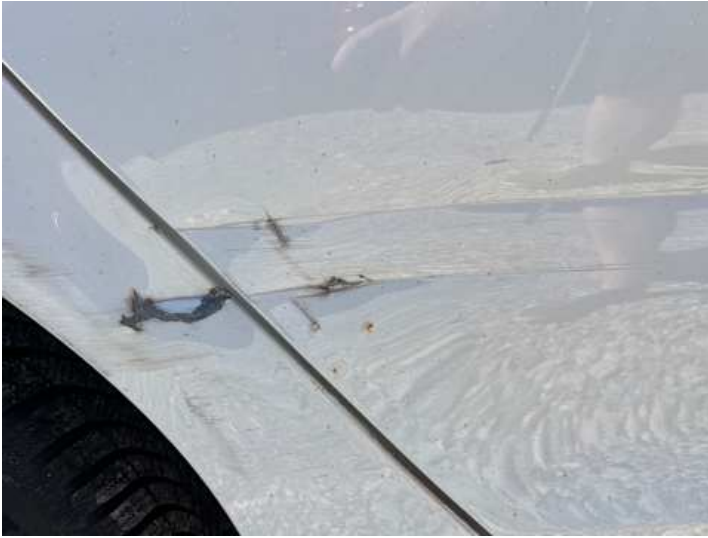
Türe hinten rechts (Verformung, Kratzer, Lackschaden)
