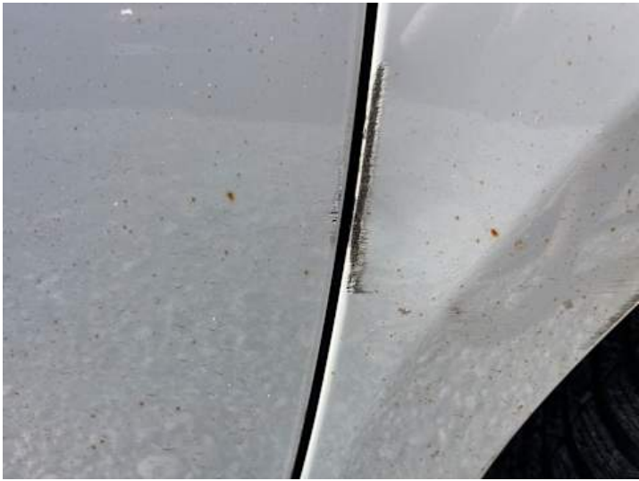
Beifahrertür (Kratzer, Lackschaden, Delle)
