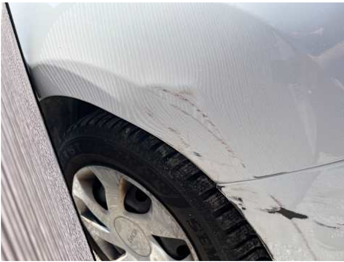
Kotflügel vorne rechts (Verformung, Kratzer, Lackschaden)
