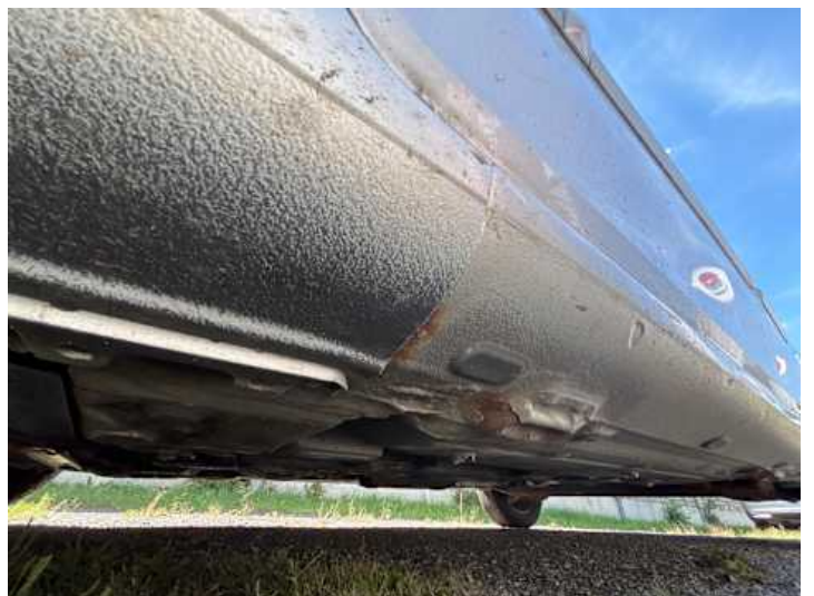
Schweller links (Rost)
