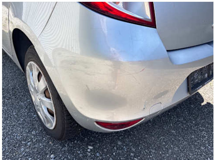
Stoßstange hinten (Riss/Bruch, Lackschaden)
