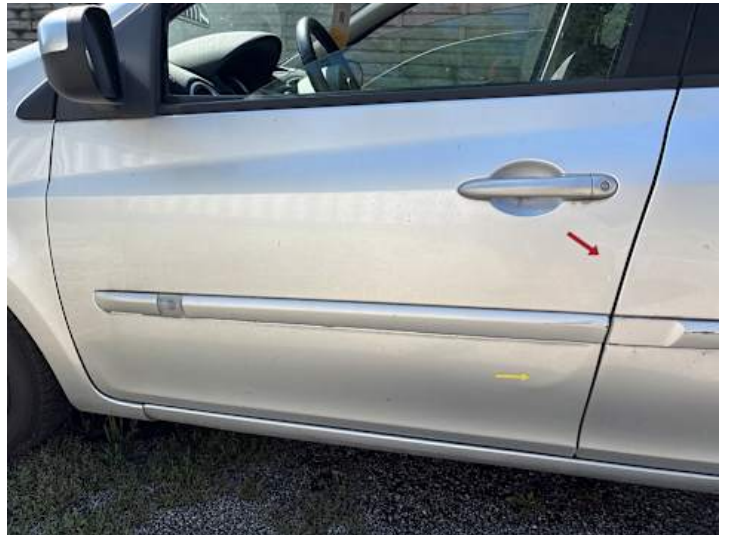
Fahrtür (Delle, Verformung, Kratzer, Lackschaden)
