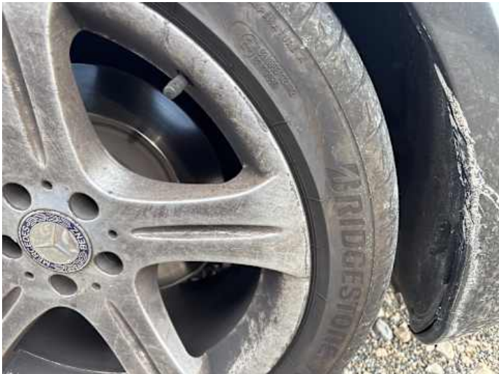
Rad (Kerben, Kratzer, Riss/Bruch)
