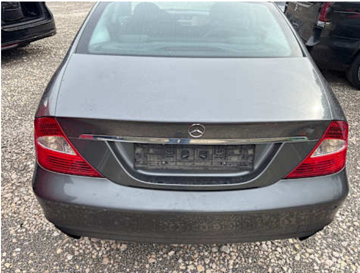
Heckklappe (Anderer Schaden): Heckklappe lässt sich nicht öffnen
