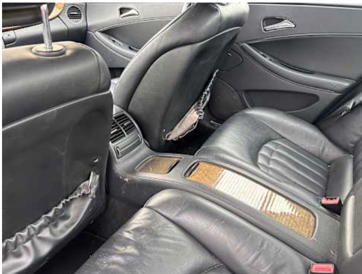
Innenraum (Diverse Schäden, Verschleiß, Verschmutzung)
