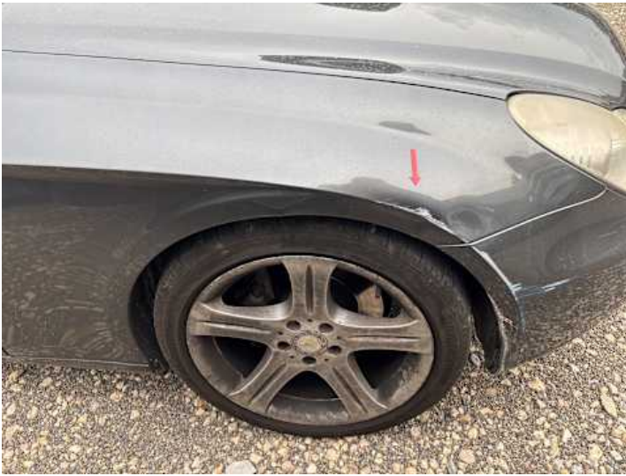
Kotflügel vorne rechts (Verformung, Lackschaden)
