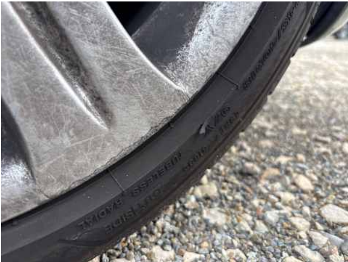
Rad (Kerben, Kratzer, Riss/Bruch)
