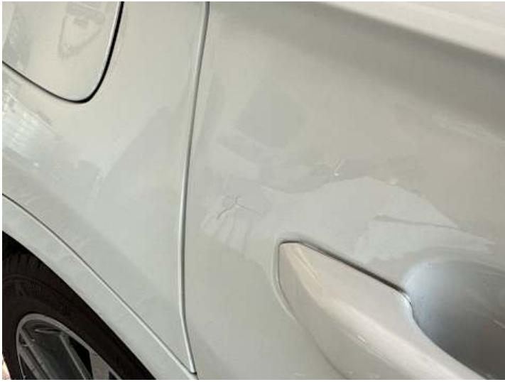
Türe hinten rechts (Lackschaden, Riss/Bruch)
