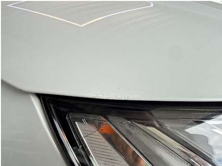
Motorhaube (Unsachgemäß instand gesetzt, Lackschaden)
