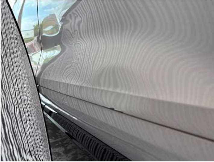
Türe hinten links (Verformung, Lackschaden, Kratzer, Delle)
