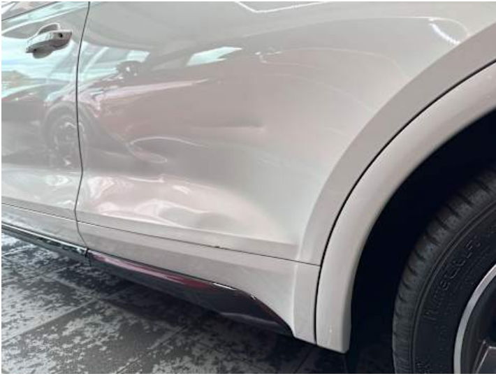
Türe hinten links (Verformung, Lackschaden, Kratzer, Delle)
