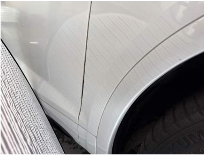
Kotflügel vorne rechts (Delle)
