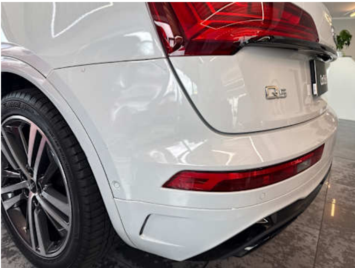
Stoßstange hinten (Lackschaden, Kratzer, Spaltmaße ungenau, Unsachgemäß instand gesetzt)
