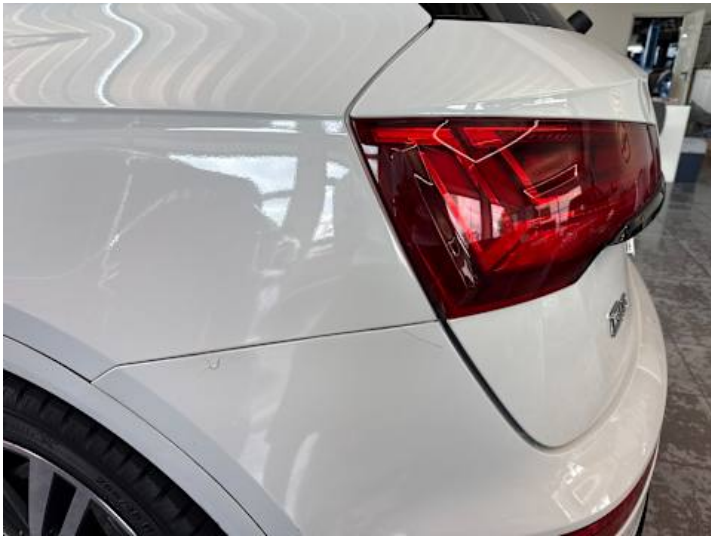
Heckklappe (Lackschaden, Kratzer, Spaltmaße ungenau)
