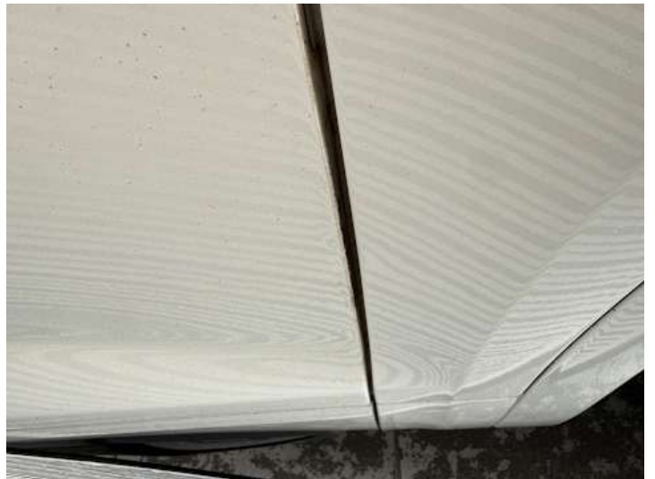
Kotflügel vorne rechts (Delle)
