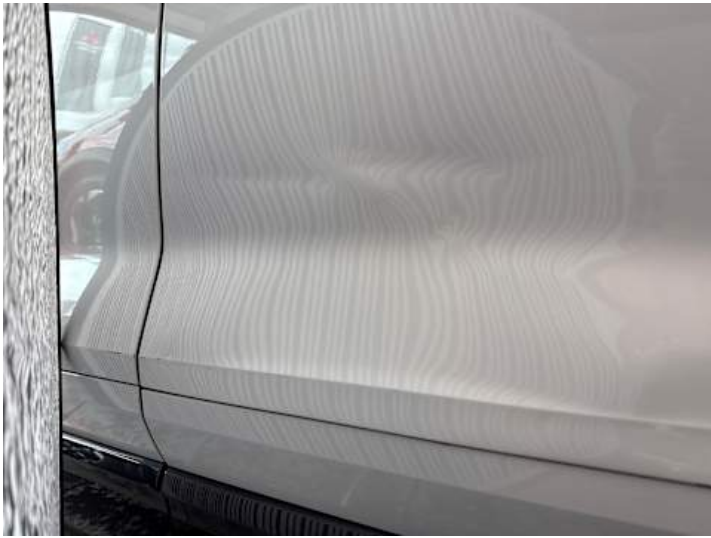
Türe hinten links (Verformung, Lackschaden, Kratzer, Delle)
