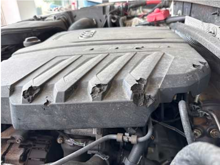
Motorhaube (Kratzer, Riss/Bruch)
