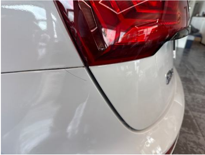
Heckklappe (Lackschaden, Kratzer, Spaltmaße ungenau)
