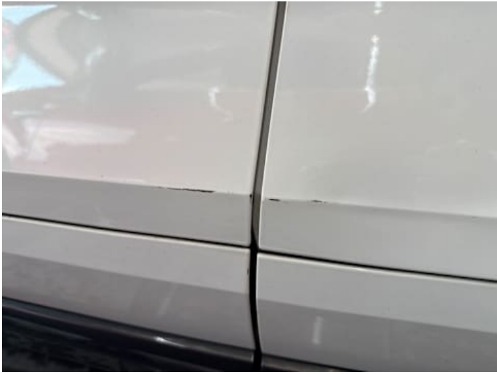
Fahrtür (Kratzer, Lackschaden)
