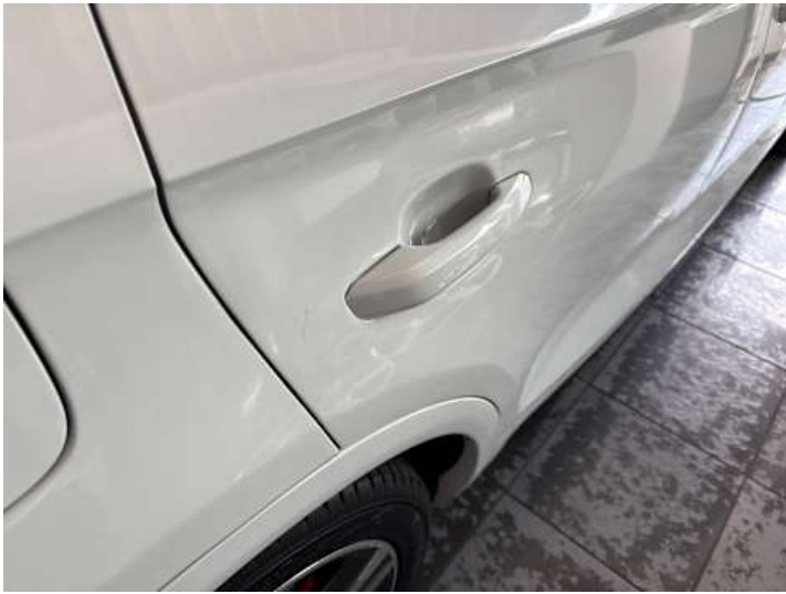
Türe hinten rechts (Lackschaden, Riss/Bruch)
