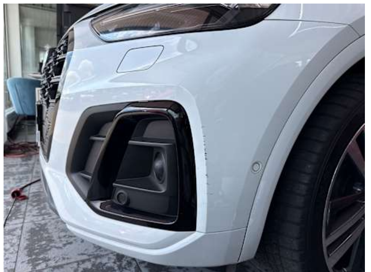
Stoßstange vorne (Lackschaden, Kratzer)
