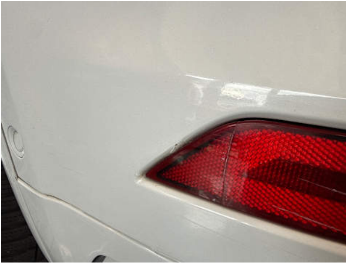
Stoßstange hinten (Lackschaden, Kratzer, Spaltmaße ungenau, Unsachgemäß instand gesetzt)
