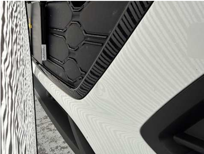
Stoßstange vorne (Delle, Verformung)
