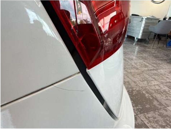
Heckklappe (Lackschaden, Kratzer, Spaltmaße ungenau)
