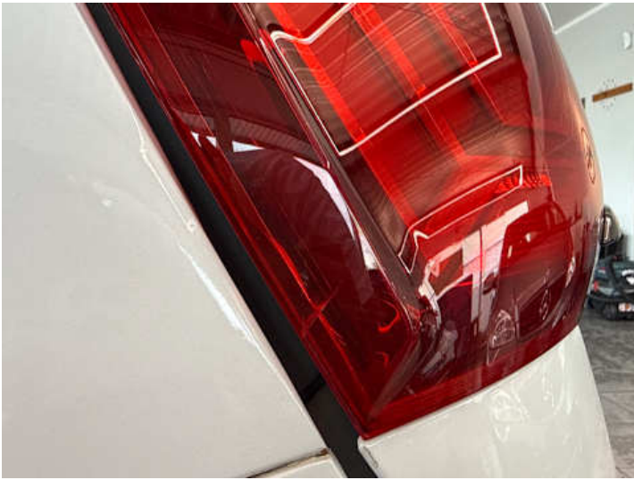
Rücklicht (links) (Riss/Bruch)
