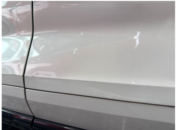
Türe hinten links (Verformung, Lackschaden, Kratzer, Delle)
