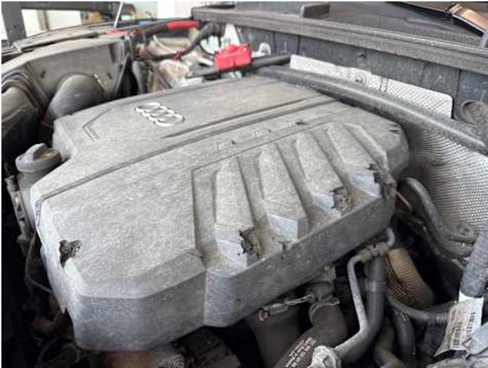
Motorhaube (Kratzer, Riss/Bruch)
