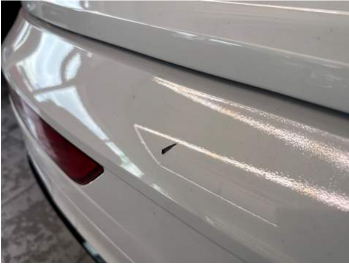
Stoßstange hinten (Lackschaden, Kratzer)
