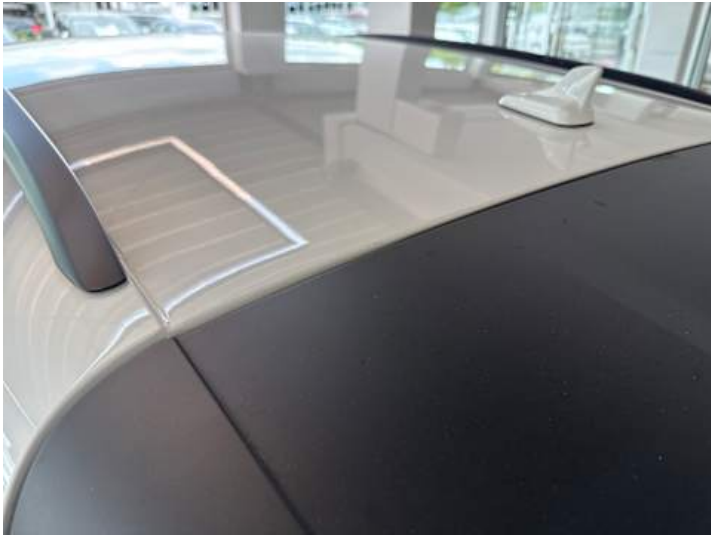
Dach (Lackschaden, Kratzer)
