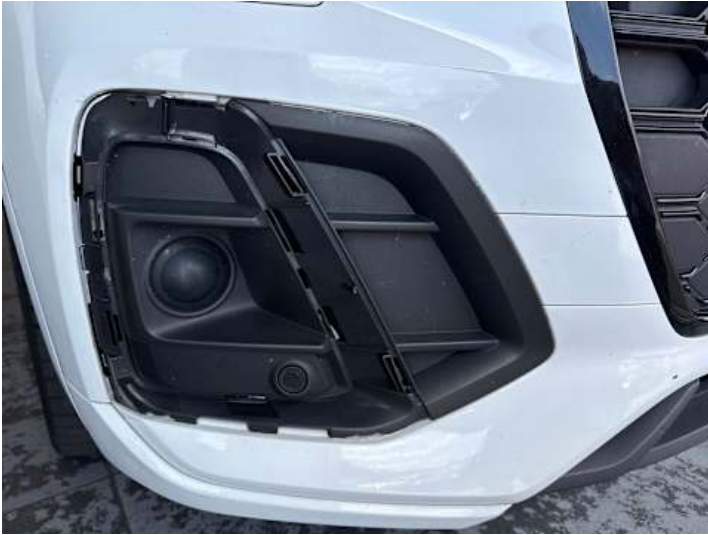
Stoßstange vorne (Steinschlag, Lackschaden, Anderer Schaden): Fehlende Abdeckung
