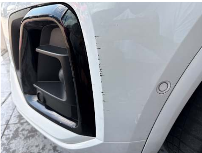
Stoßstange vorne (Lackschaden, Kratzer)
