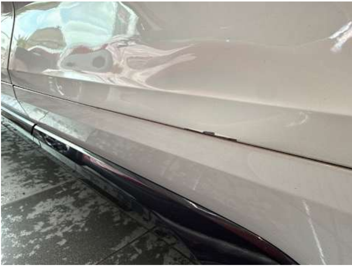
Türe hinten links (Verformung, Lackschaden, Kratzer, Delle)
