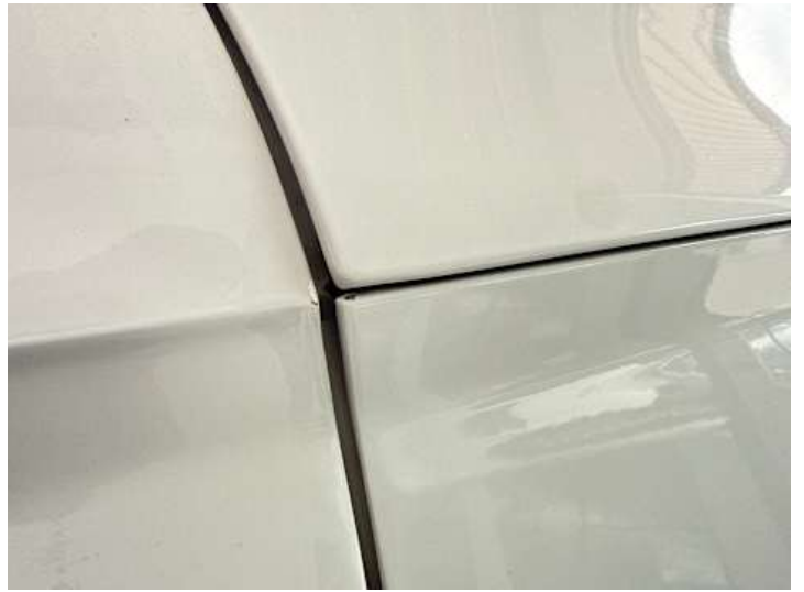
Kotflügel vorne rechts (Lackschaden)
