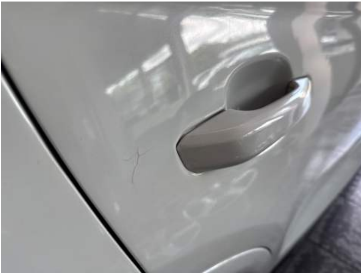
Türe hinten rechts (Lackschaden, Riss/Bruch)
