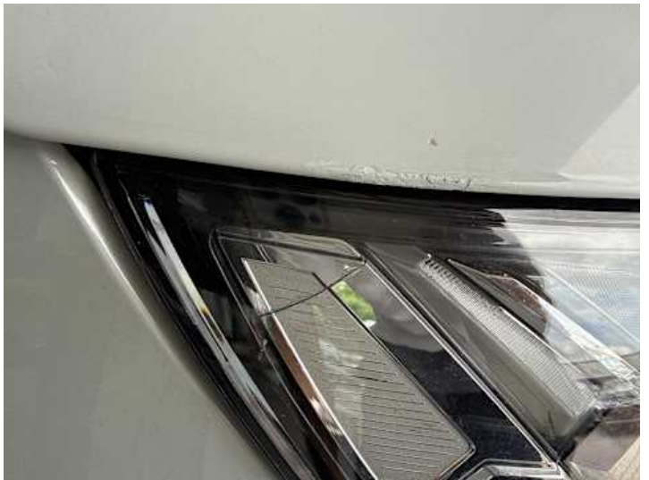
Scheinwerfer (rechts) (Riss/Bruch, Kratzer)
