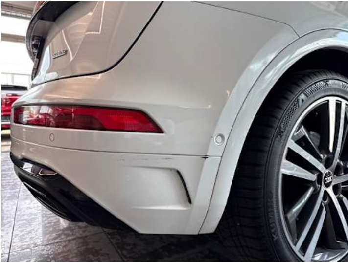
Stoßstange hinten (Lackschaden, Kratzer)
