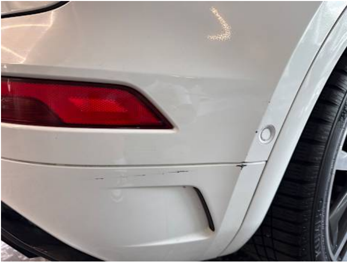
Stoßstange hinten (Lackschaden, Kratzer)
