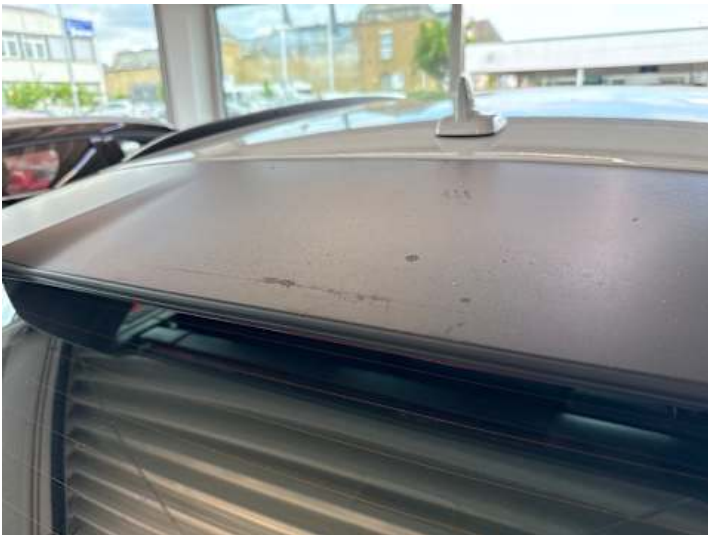
Heckklappe (Unsachgemäß instand gesetzt)
