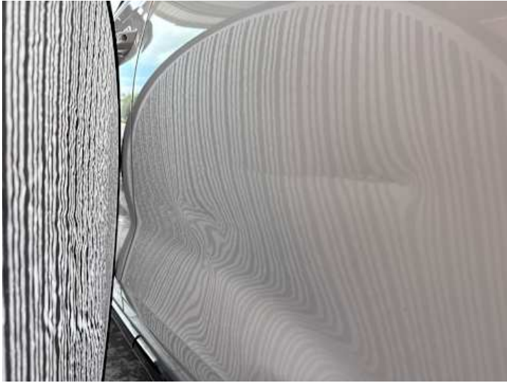
Türe hinten links (Verformung, Lackschaden, Kratzer, Delle)
