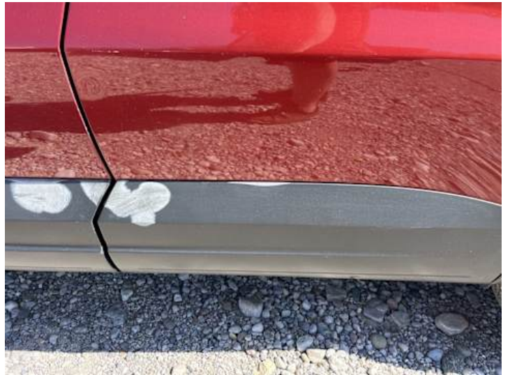
Türe hinten links (Ausgeblichen/Matt, Delle)
