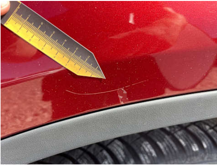
Kotflügel vorne links (Kratzer, Lackschaden)
