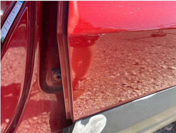
Türe hinten links (Ausgeblichen/Matt, Delle)
