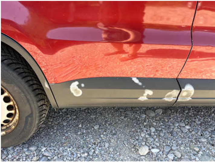
Türe hinten rechts (Ausgeblichen/Matt, Delle)
