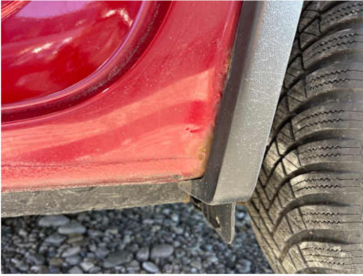
Seitenteil hinten links (Lackschaden, Rost)
