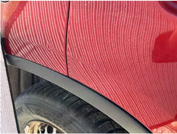
Türe hinten rechts (Ausgeblichen/Matt, Delle)
