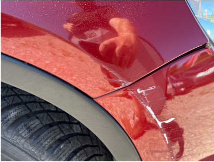
Kotflügel vorne rechts (Kratzer, Lackschaden)
