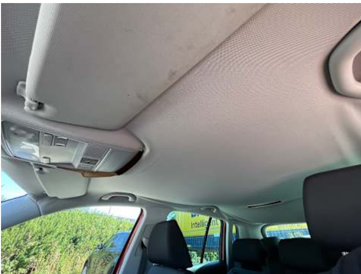
Innenraum (Anderer Schaden): Dachhimmel hängt;
