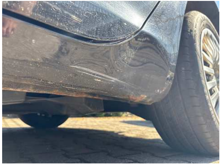
Schweller links (Lackschaden, Rost, Verformung)
