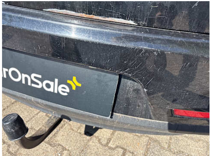
Stoßstange hinten (Kratzer, Lackschaden)
