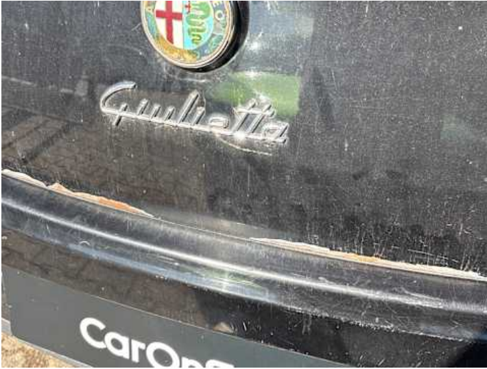
Heckklappe (Kratzer, Lackschaden, Rost)
