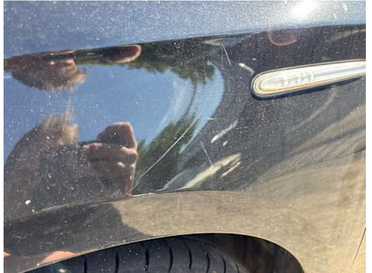
Kotflügel vorne links (Kratzer)
