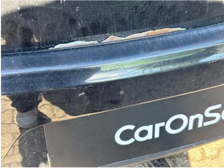
Heckklappe (Kratzer, Lackschaden, Rost)
