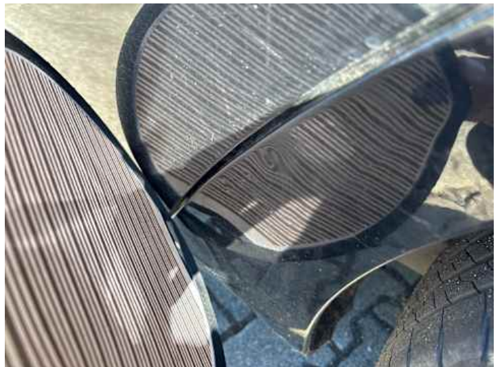
Seitenteil hinten links (Delle, Verformung)
