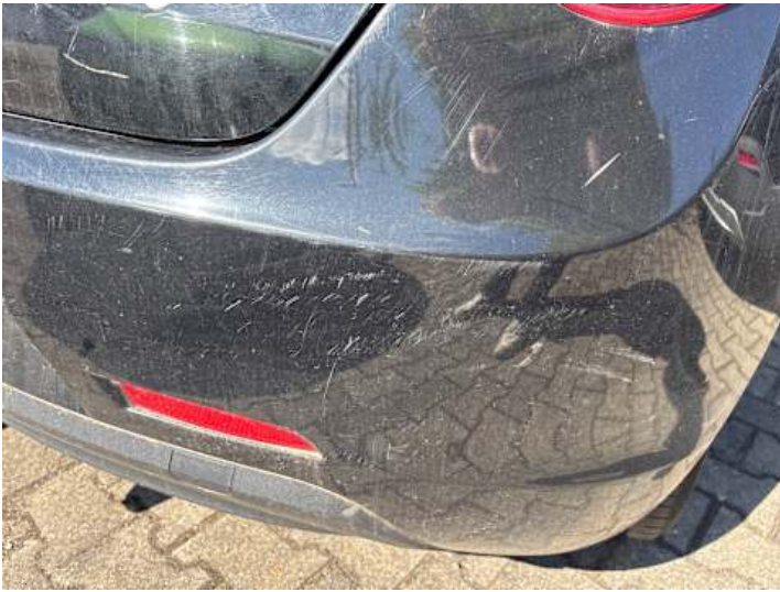
Stoßstange hinten (Kratzer, Lackschaden)
