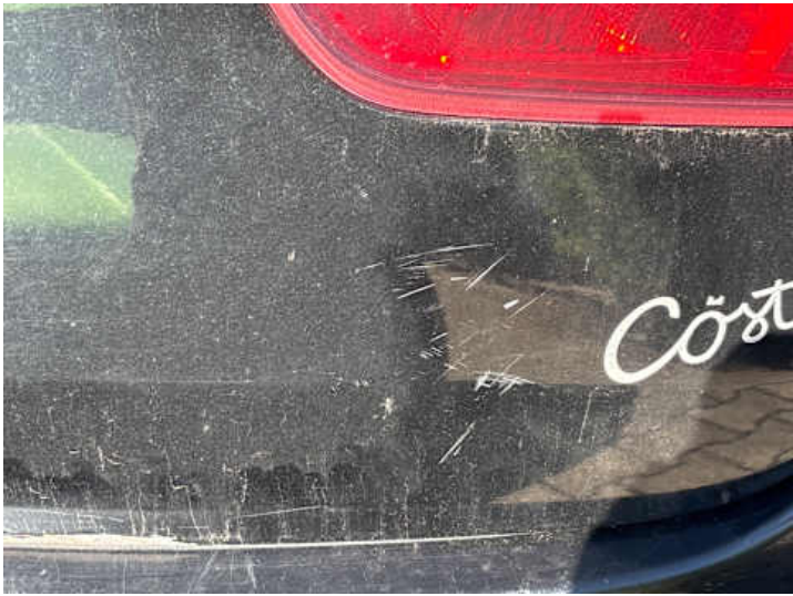
Heckklappe (Kratzer, Lackschaden, Rost)
