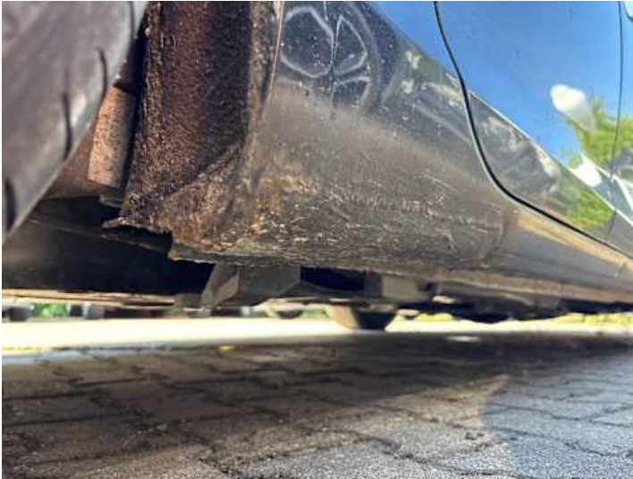
Schweller rechts (Lackschaden, Rost, Verformung, Unsachgemäß instand gesetzt)
