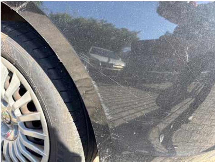
Stoßstange hinten (Kratzer, Lackschaden)
