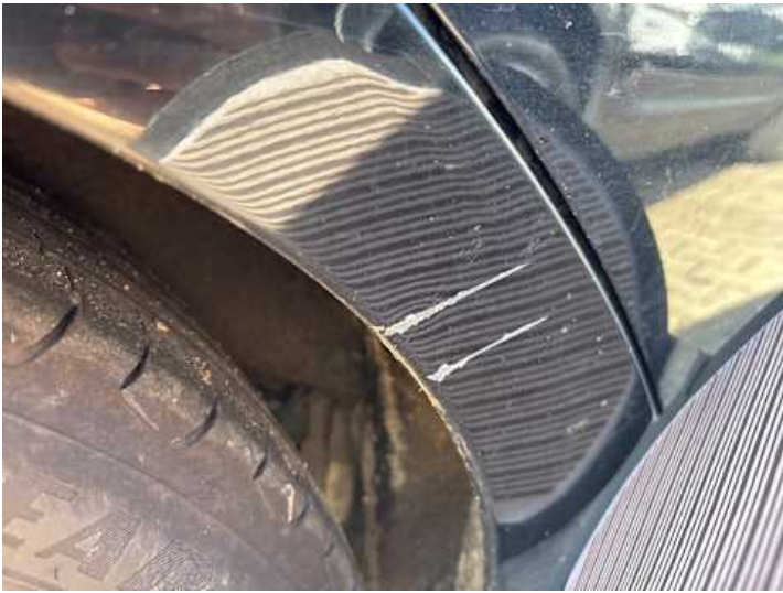
Seitenteil hinten rechts (Kratzer, Lackschaden, Verformung)
