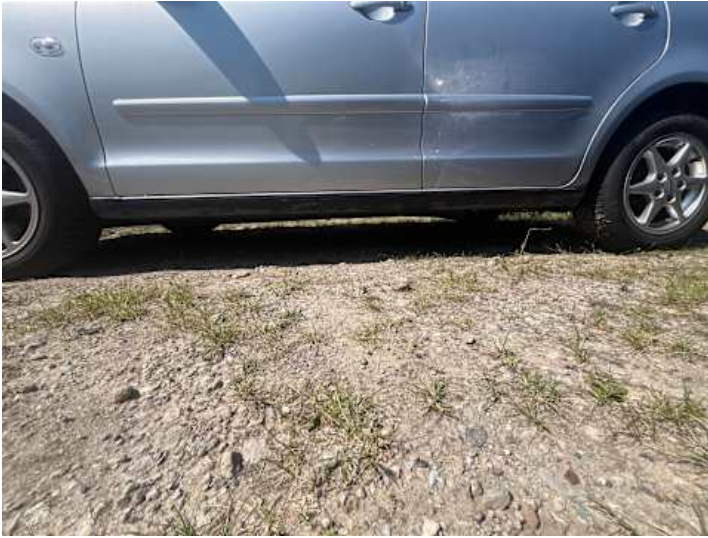
Schweller links (Unsachgemäß instand gesetzt, Lackschaden)
