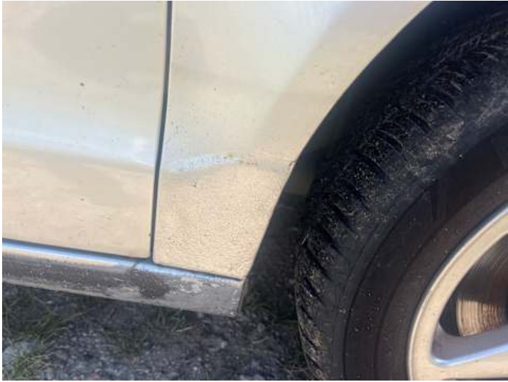
Kotflügel vorne rechts (Lackschaden, Rost)
