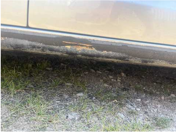
Schweller rechts (Lackschaden, Unsachgemäß instand gesetzt, Rost)
