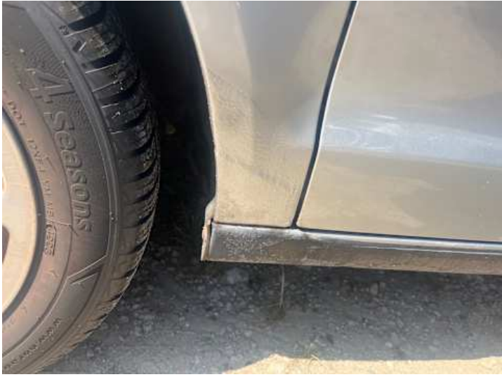
Kotflügel vorne links (Lackschaden, Rost)
