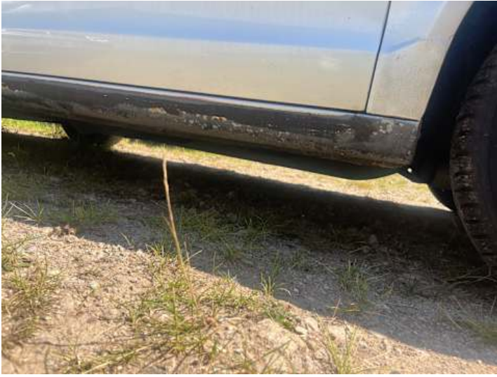
Schweller rechts (Lackschaden, Unsachgemäß instand gesetzt, Rost)
