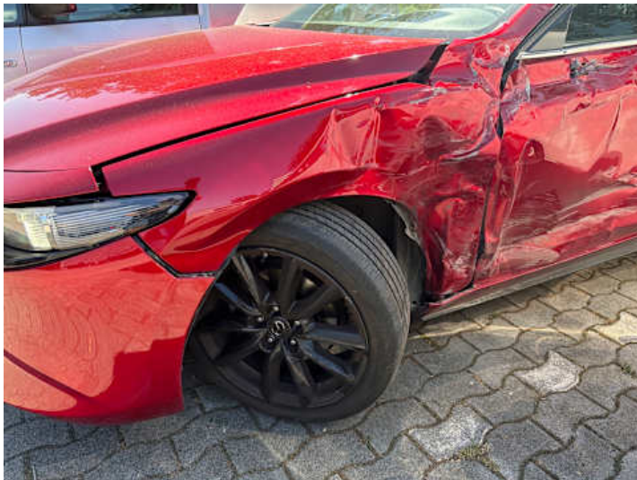
Kotflügel vorne links (Verformung, Anderer Schaden): Unfall
