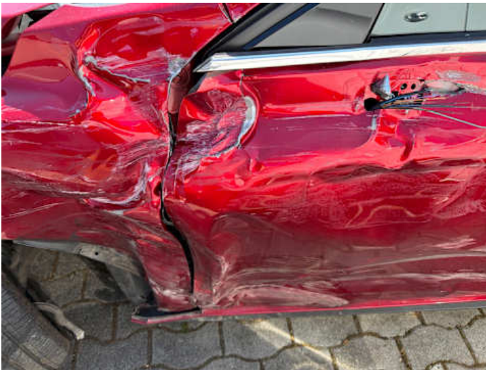
Fahrtür (Verformung, Anderer Schaden): Unfall
