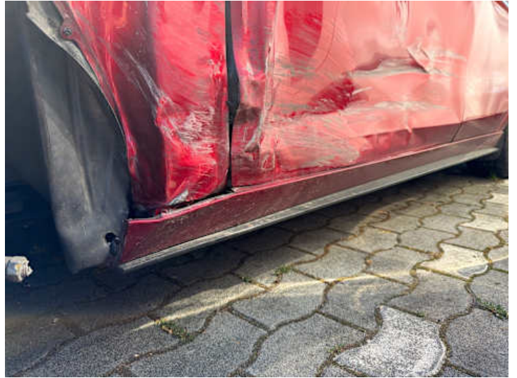
Fahrtür (Verformung, Anderer Schaden): Unfall
