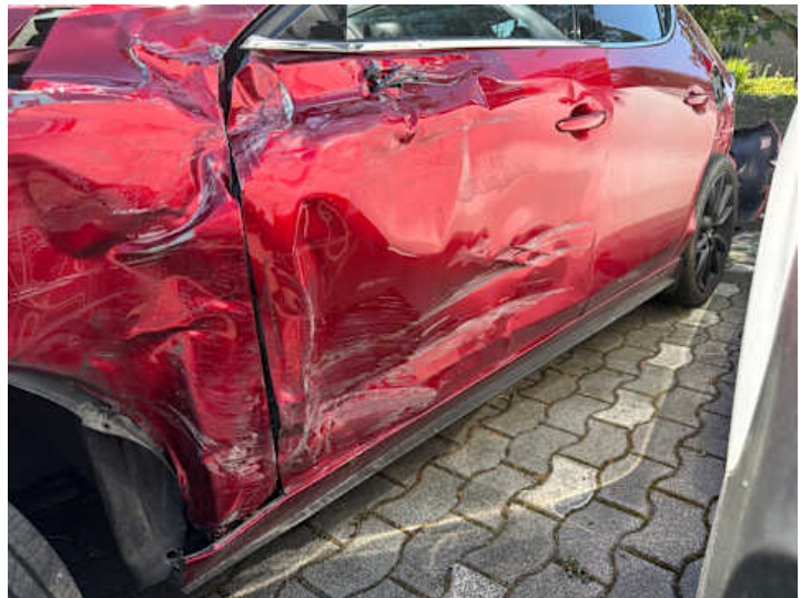
Fahrtür (Verformung, Anderer Schaden): Unfall
