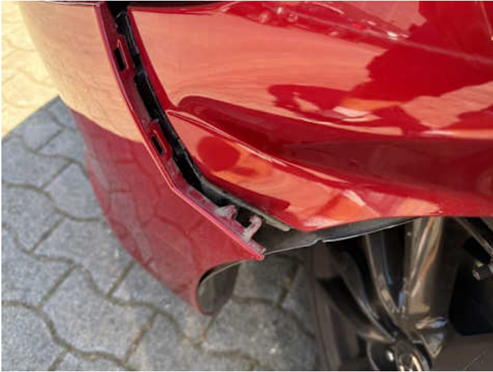
Stoßstange vorne (Riss/Bruch)
