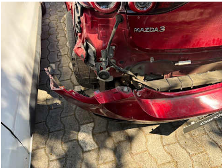
Stoßstange hinten (Anderer Schaden, Riss/Bruch): Unfall
