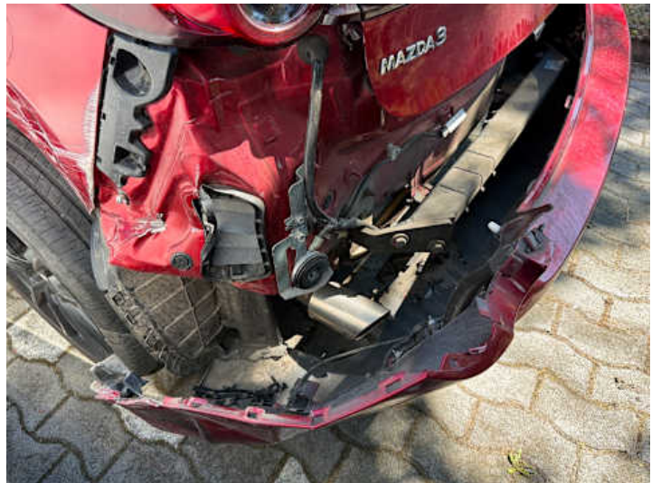
Stoßstange hinten (Anderer Schaden, Riss/Bruch): Unfall
