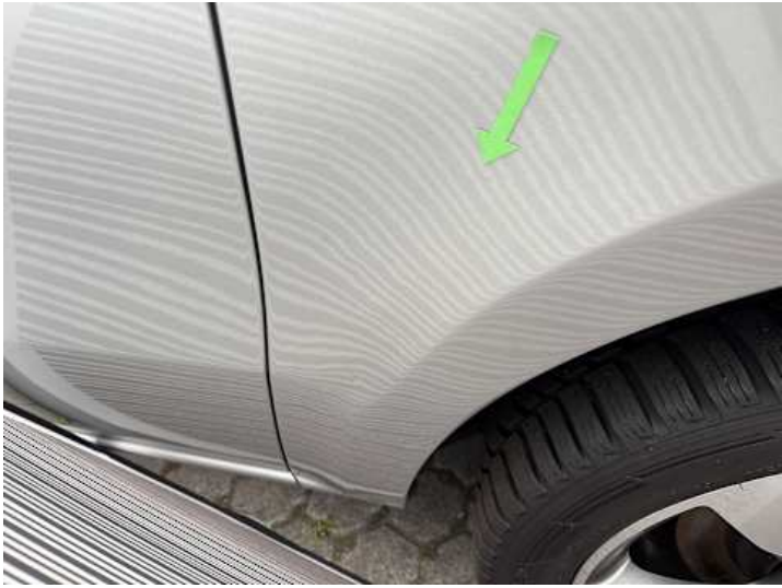
Seitenteil hinten links (Unsachgemäß instand gesetzt)
