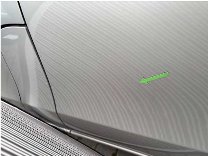
Türe hinten links (Unsachgemäß instand gesetzt)
