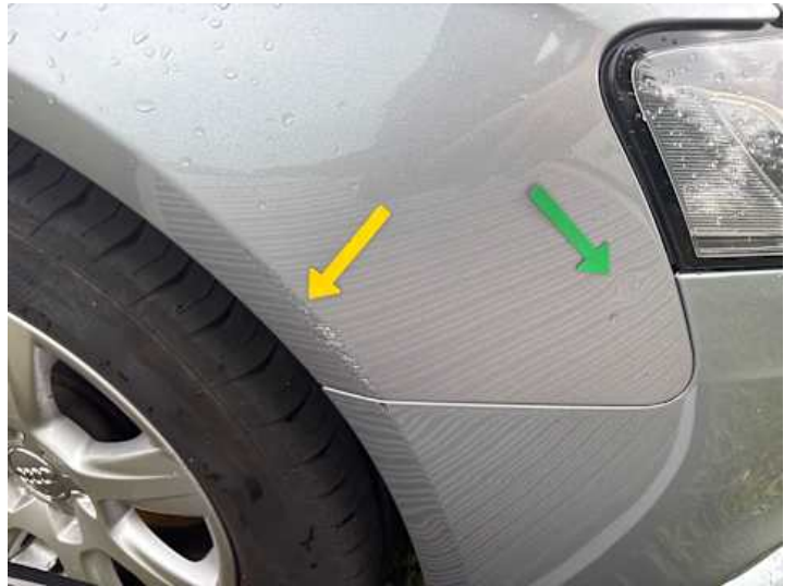
Kotflügel vorne rechts (Kratzer, Delle, Lackschaden, Verformung)
