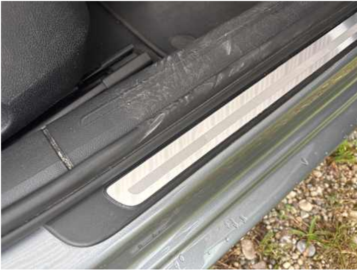
Schweller rechts (Delle)
