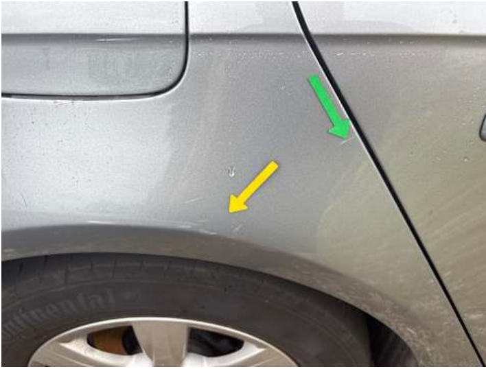
Seitenteil hinten rechts (Lackschaden, Kratzer)
