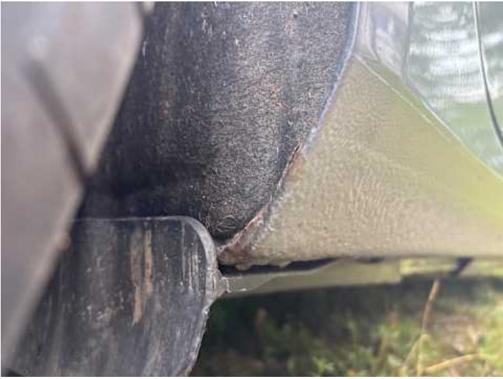
Schweller rechts (Lackschaden, Rost)
