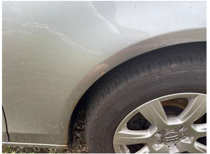
Kotflügel vorne rechts (Lackschaden, Rost)
