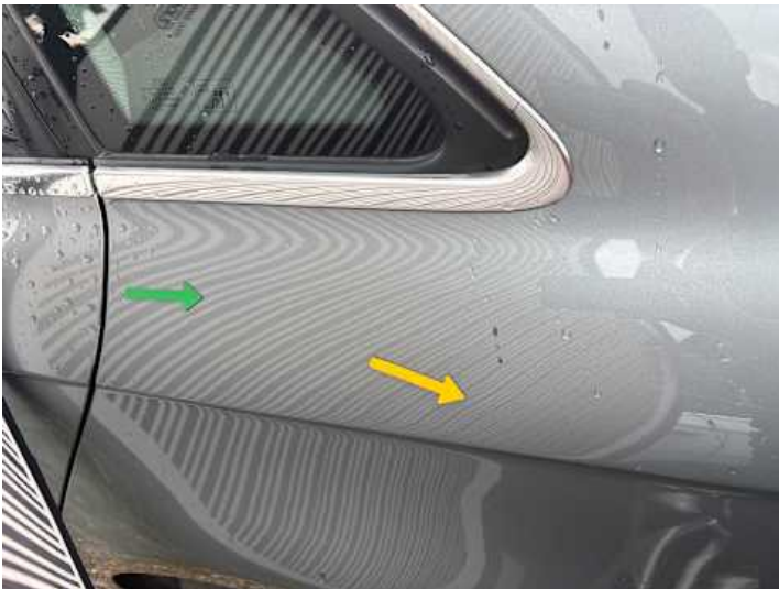
Seitenteil hinten links (Delle)
