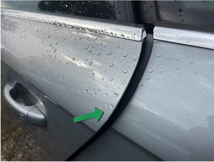
Türe hinten links (Kratzer, Lackschaden)
