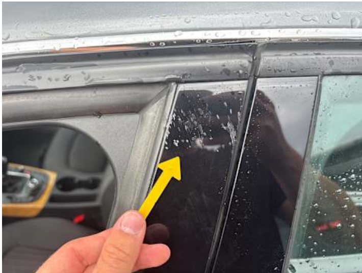
Fahrertür (Kratzer, Lackschaden)
