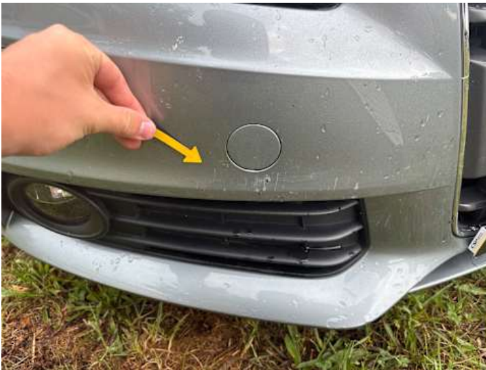
Stoßstange vorne (Kratzer, Lackschaden)
