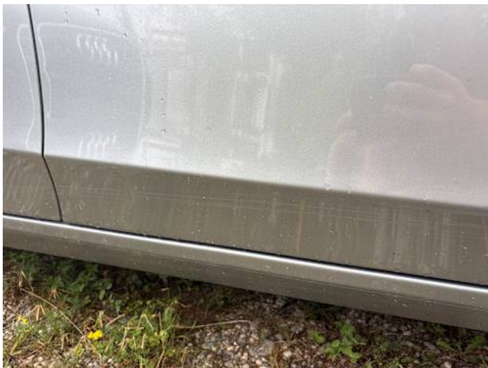
Beifahrertür (Kratzer, Lackschaden)
