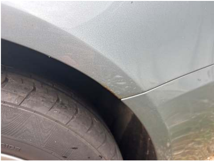
Seitenteil hinten links (Lackschaden, Rost, Kratzer)
