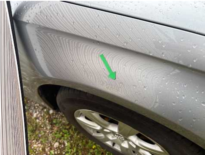
Kotflügel vorne rechts (Kratzer, Delle, Lackschaden, Verformung)
