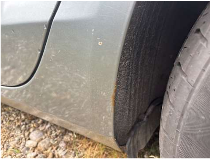
Seitenteil hinten links (Lackschaden, Rost, Kratzer)
