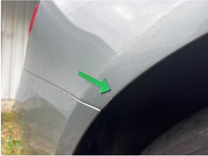
Seitenteil hinten rechts (Lackschaden, Rost)
