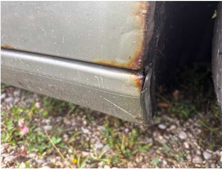
Schweller rechts (Lackschaden, Rost)
