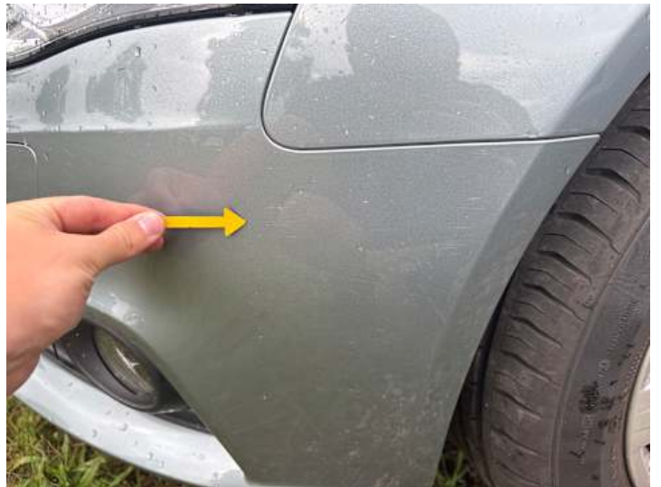
Stoßstange vorne (Kratzer, Lackschaden)
