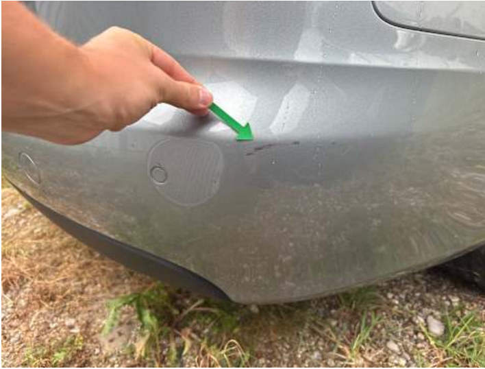
Stoßstange hinten (Kratzer, Lackschaden)
