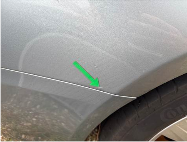
Seitenteil hinten rechts (Lackschaden, Rost)
