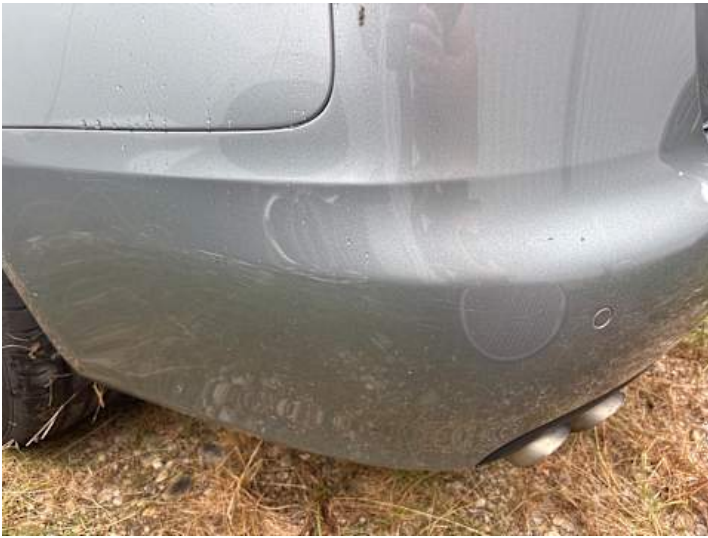
Stoßstange hinten (Kratzer, Lackschaden)
