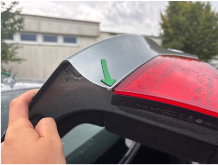
Heckklappe (Lackschaden, Kratzer)
