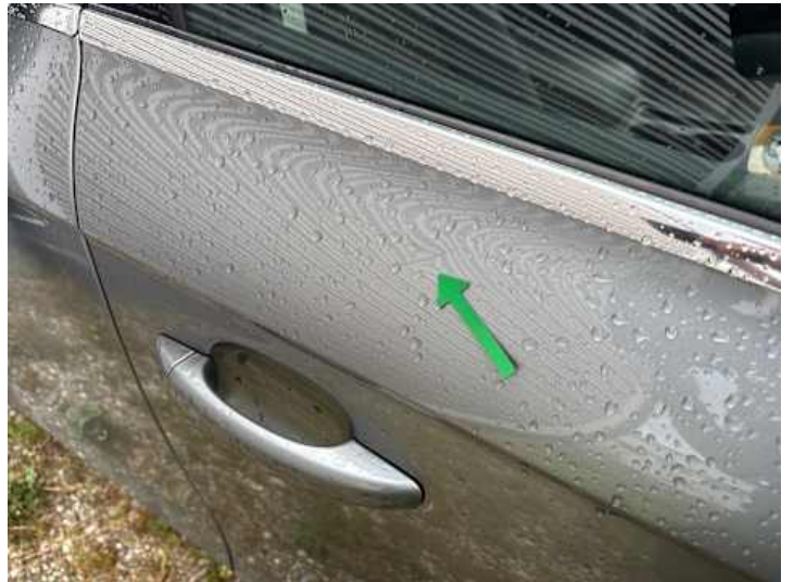
Beifahrertür (Delle, Kratzer, Lackschaden)
