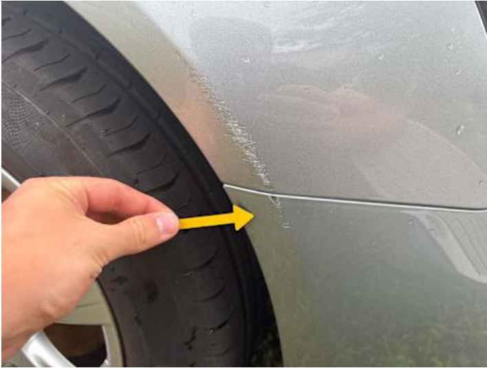
Stoßstange vorne (Kratzer, Lackschaden)
