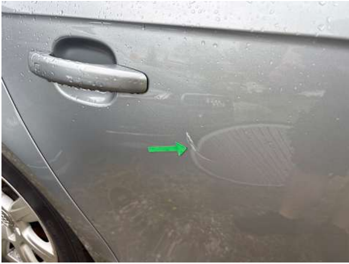
Türe hinten rechts (Kratzer, Lackschaden)
