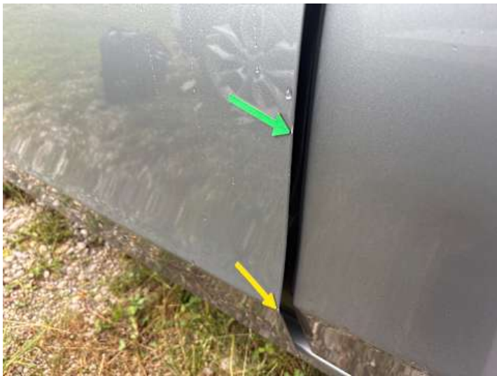
Fahrertür (Lackschaden, Rost)
