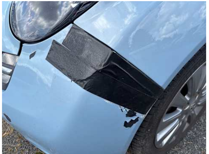
Stoßstange vorne (Unsachgemäß instand gesetzt, Riss/Bruch)
