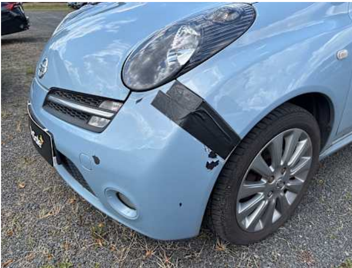
Stoßstange vorne (Unsachgemäß instand gesetzt, Riss/Bruch)
