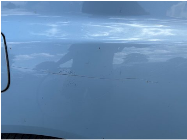
Seitenteil hinten rechts (Kratzer, Lackschaden, Rost)
