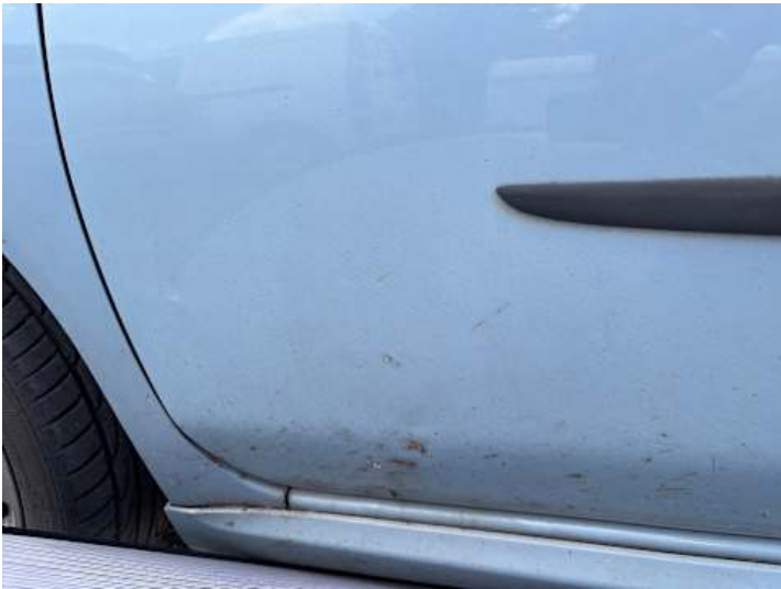
Fahrtür (Delle, Kratzer)
