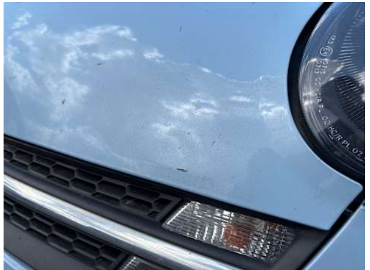
Motorhaube (Delle, Kratzer)
