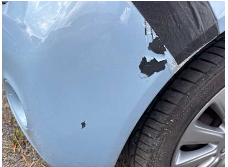
Stoßstange vorne (Kratzer, Lackschaden)
