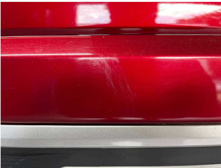
Stoßstange hinten (Kratzer, Lackschaden, Unsachgemäß instand gesetzt)
