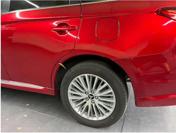
Seitenteil hinten links (Lackschaden, Delle)
