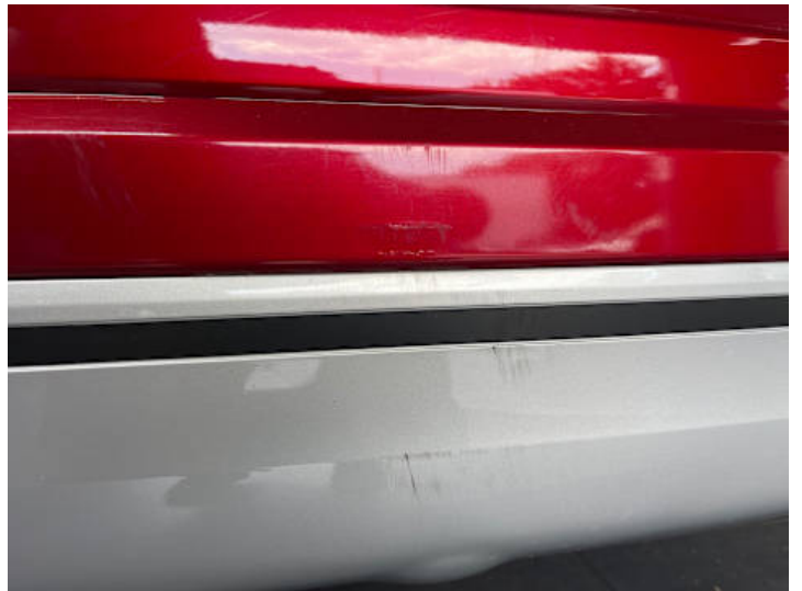
Stoßstange hinten (Kratzer, Lackschaden, Unsachgemäß instand gesetzt)
