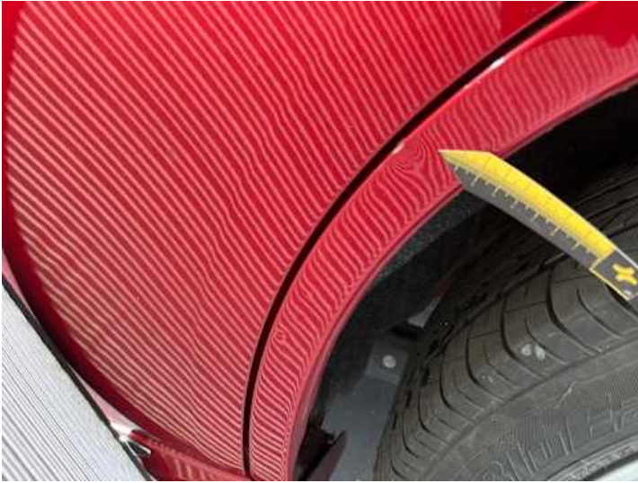
Seitenteil hinten links (Lackschaden, Delle)
