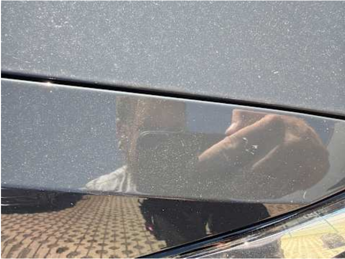
Kotflügel vorne rechts (Kratzer, Lackschaden)
