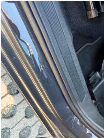
Schweller rechts (Kratzer)
