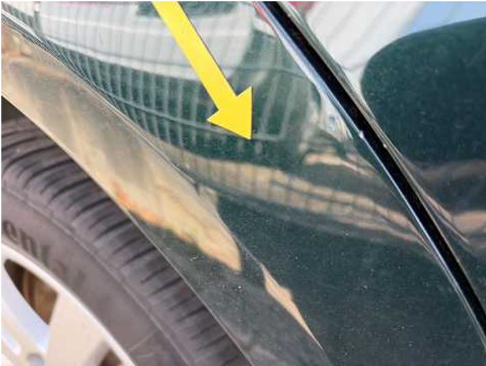
Seitenteil hinten rechts (Kratzer, Verformung)
