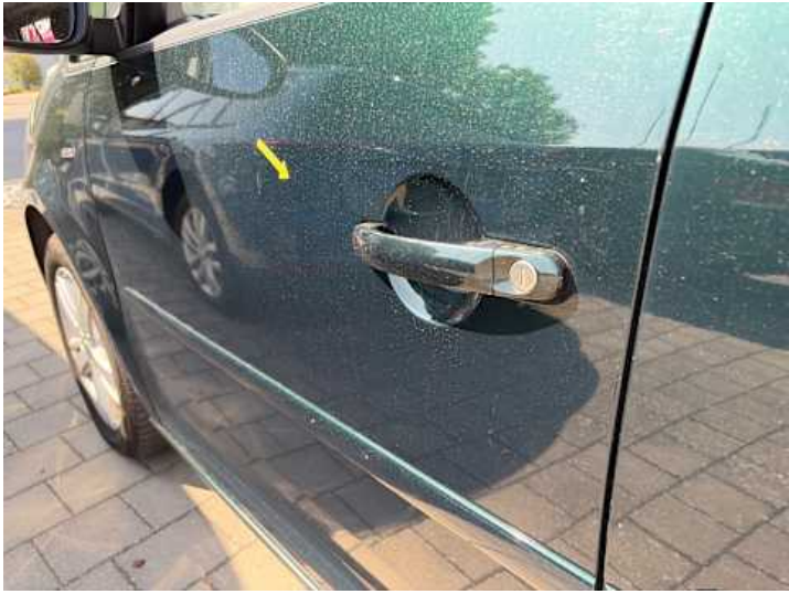
Fahrtür (Kratzer, Delle)
