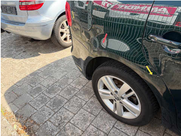
Seitenteil hinten rechts (Kratzer, Verformung)
