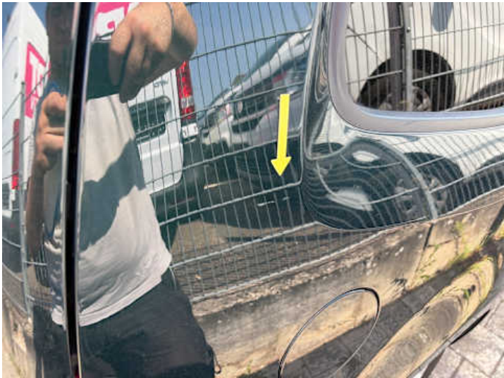
Seitenteil hinten rechts (Kratzer, Verformung)
