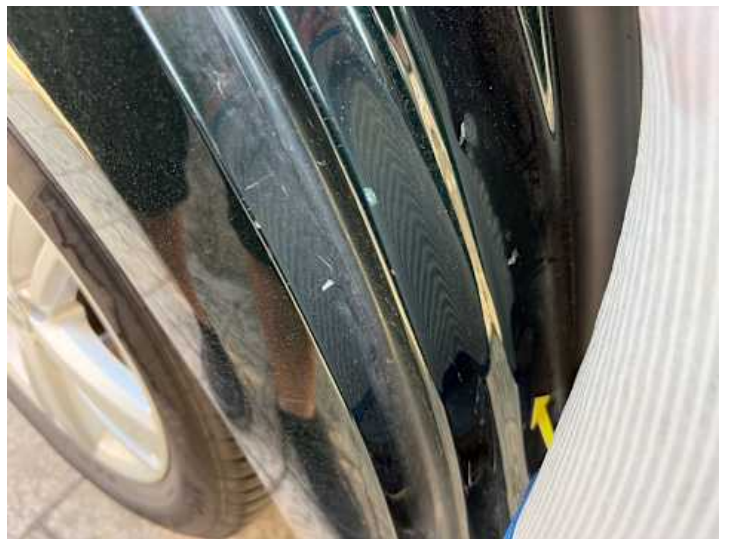
Türe hinten rechts (Kratzer, Delle)
