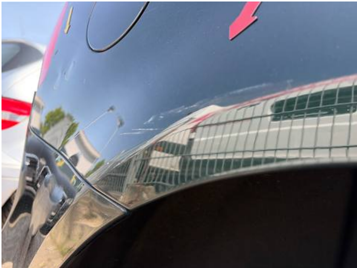
Seitenteil hinten rechts (Kratzer, Verformung)
