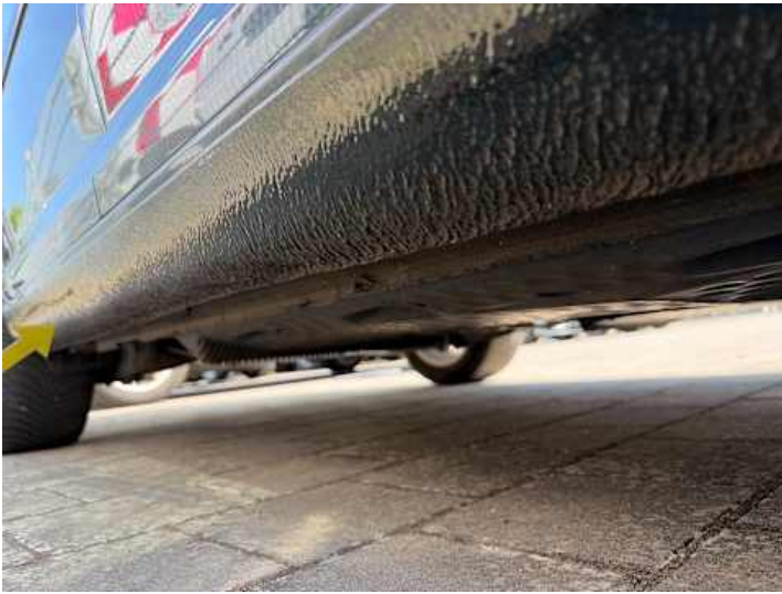
Schweller rechts (Verformung)
