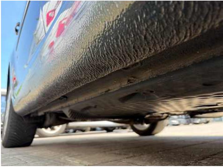
Schweller rechts (Verformung)
