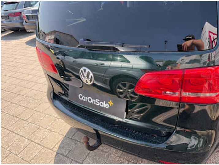
Heckklappe (Kratzer, Delle)
