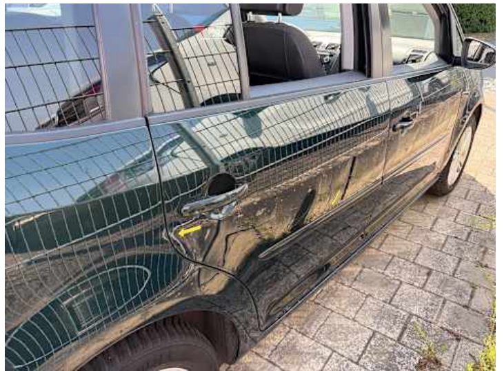
Türe hinten rechts (Kratzer, Delle)
