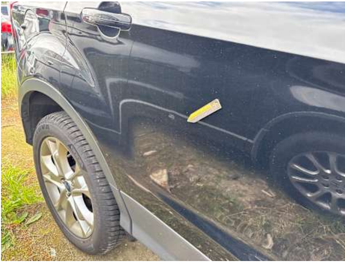
Türe hinten rechts (Delle)
