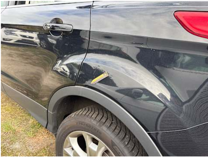
Seitenteil hinten links (Delle)
