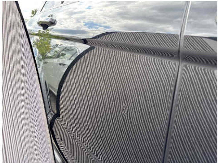
Türe hinten rechts (Delle, Kratzer)
