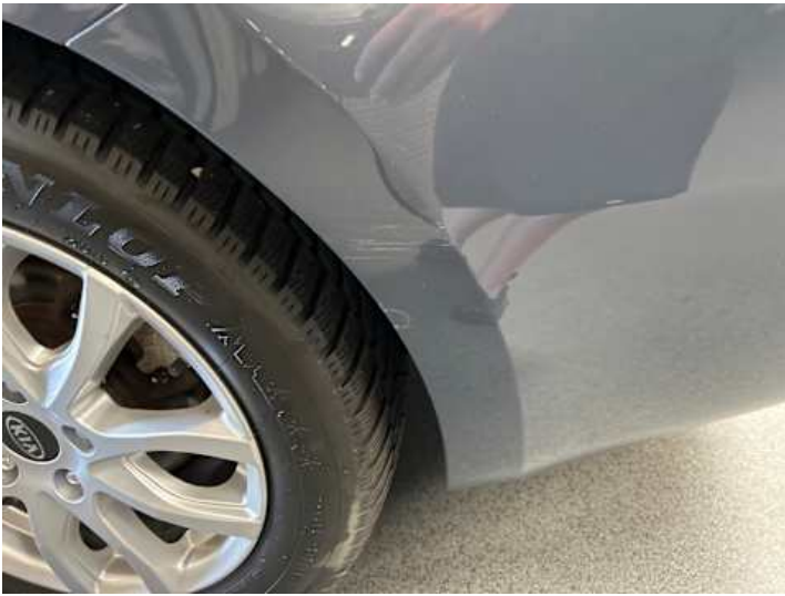
Stoßstange hinten (Kratzer)
