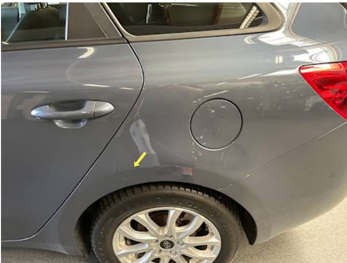
Seitenteil hinten links (Delle)
