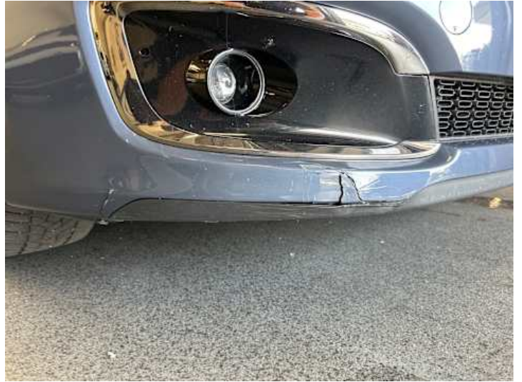
Stoßstange vorne (Riss/Bruch)
