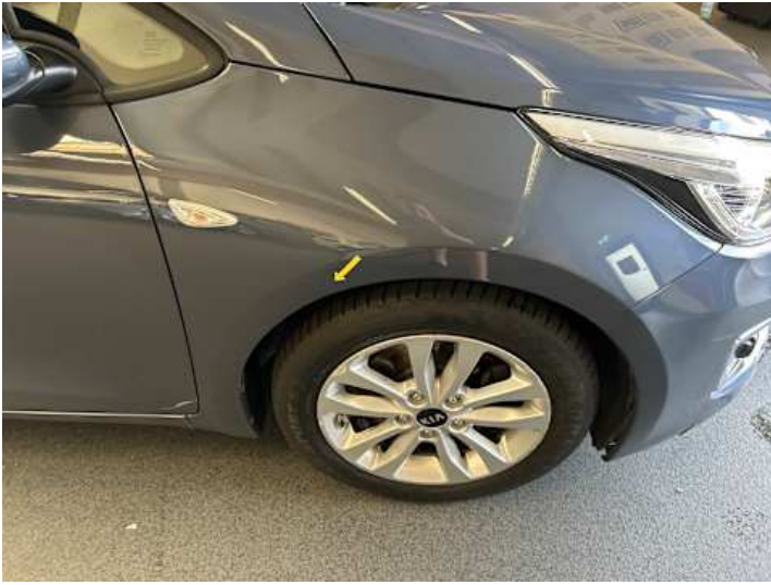
Kotflügel vorne rechts (Delle)
