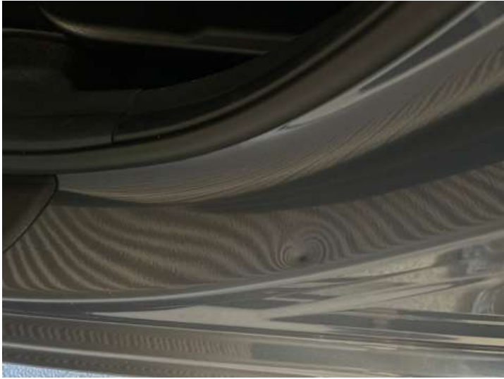
Schweller links (Delle)
