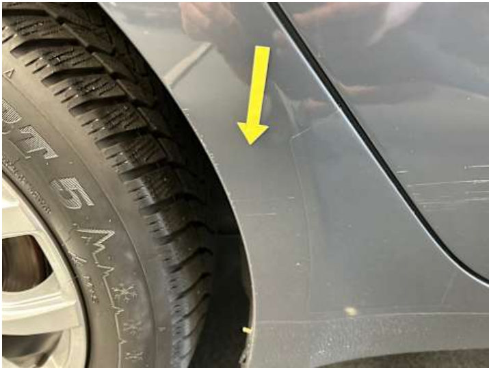
Seitenteil hinten rechts (Kratzer)
