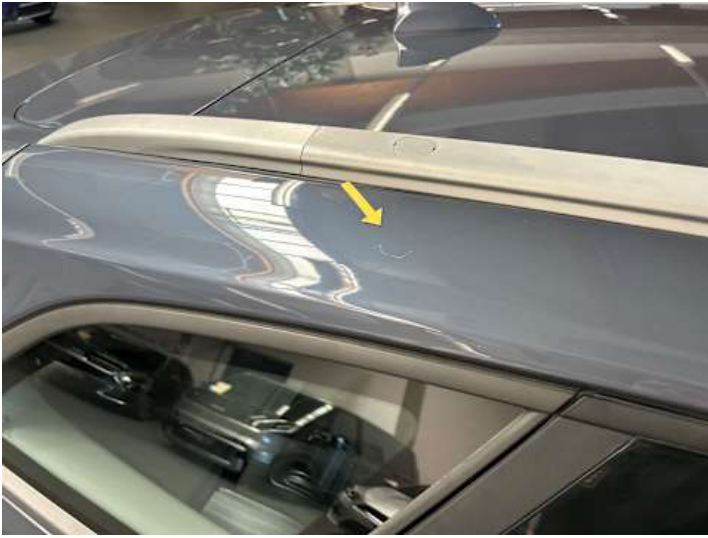
Seitenteil hinten rechts (Kratzer)
