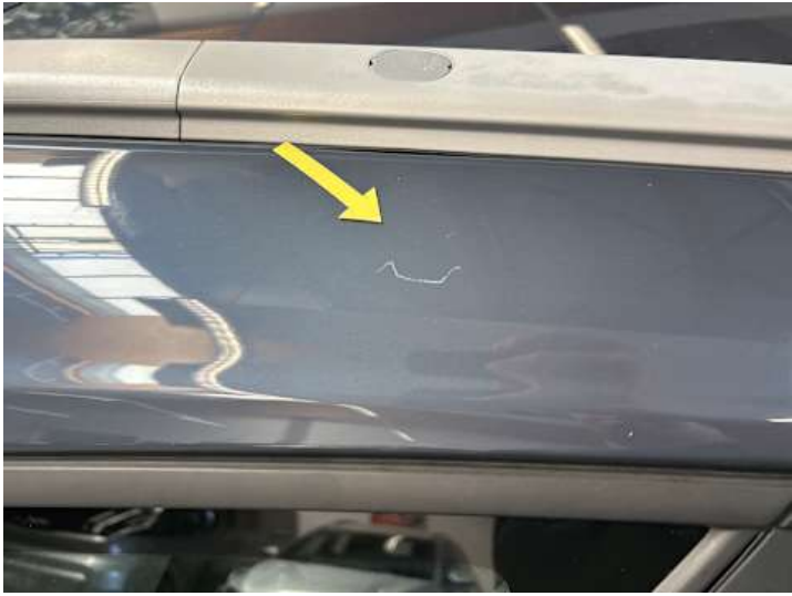
Seitenteil hinten rechts (Kratzer)
