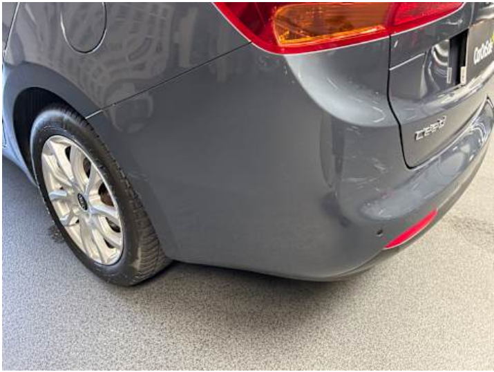
Stoßstange hinten (Kratzer)
