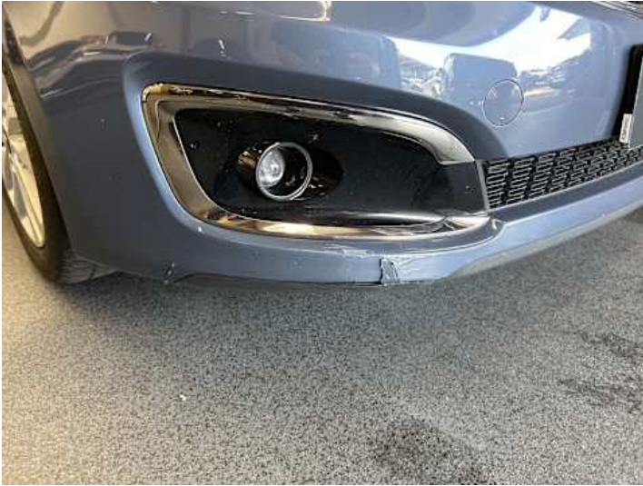
Stoßstange vorne (Riss/Bruch)
