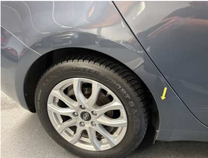
Seitenteil hinten rechts (Kratzer)
