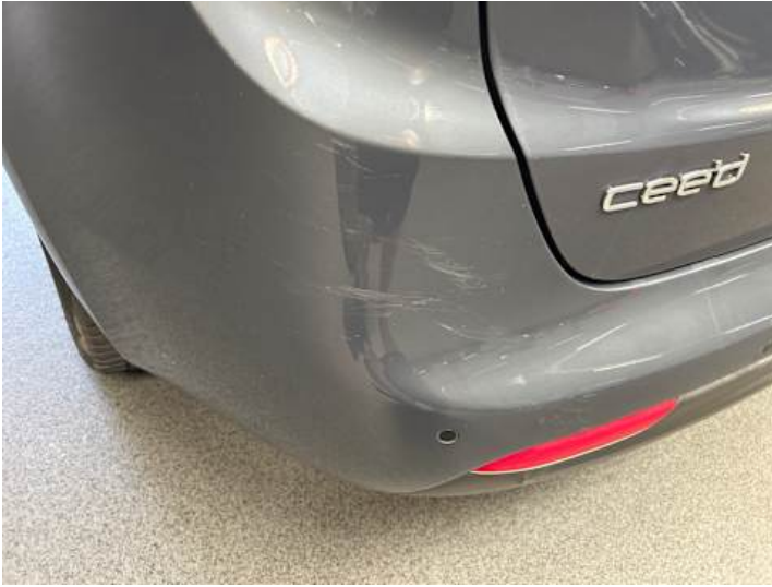
Stoßstange hinten (Kratzer)
