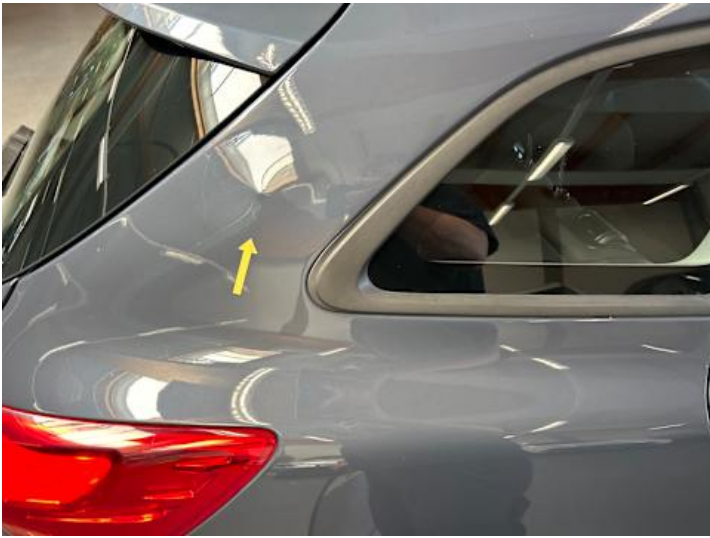
Seitenteil hinten rechts (Delle)
