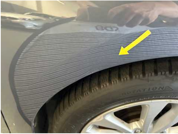
Kotflügel vorne rechts (Delle)
