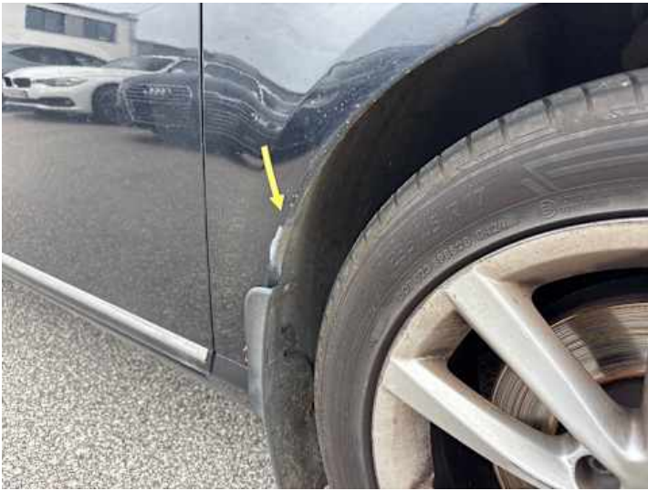
Kotflügel vorne rechts (Steinschlag, Rost)
