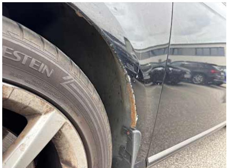
Kotflügel vorne links (Rost, Steinschlag)
