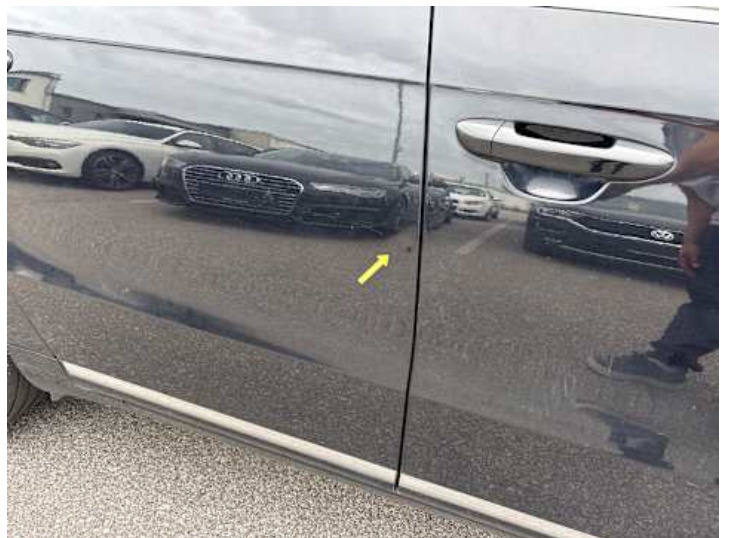
Türe hinten rechts (Delle, Rost)
