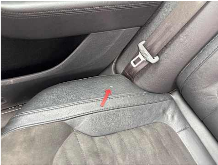
Innenraum (Riss/Bruch, Brandloch)
