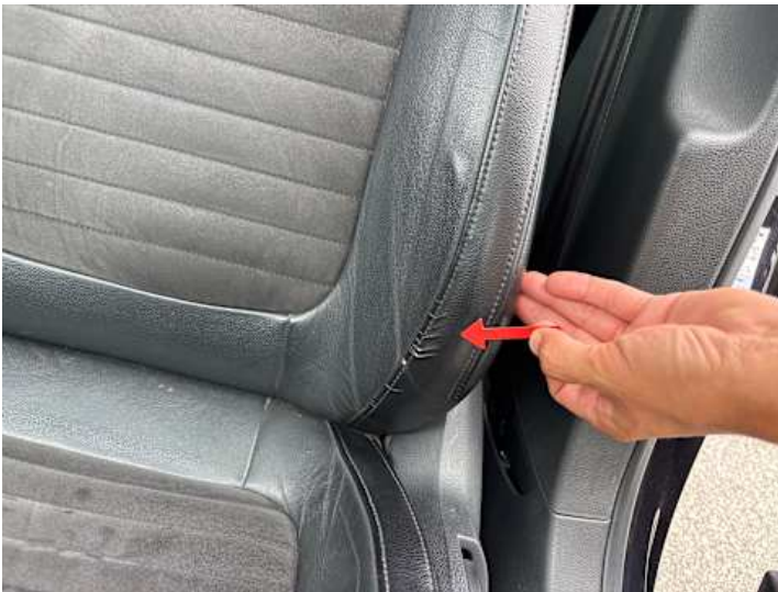
Innenraum (Riss/Bruch, Brandloch)
