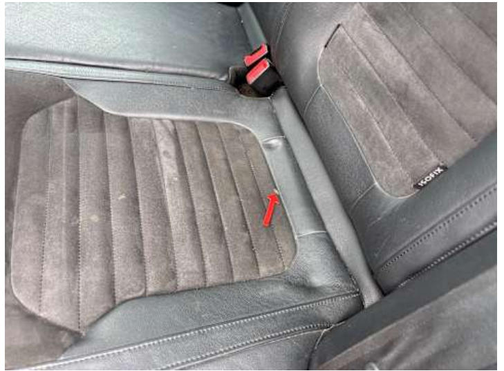
Innenraum (Riss/Bruch, Brandloch)
