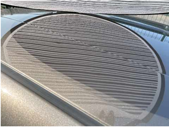
Dach (Delle, Kratzer)
