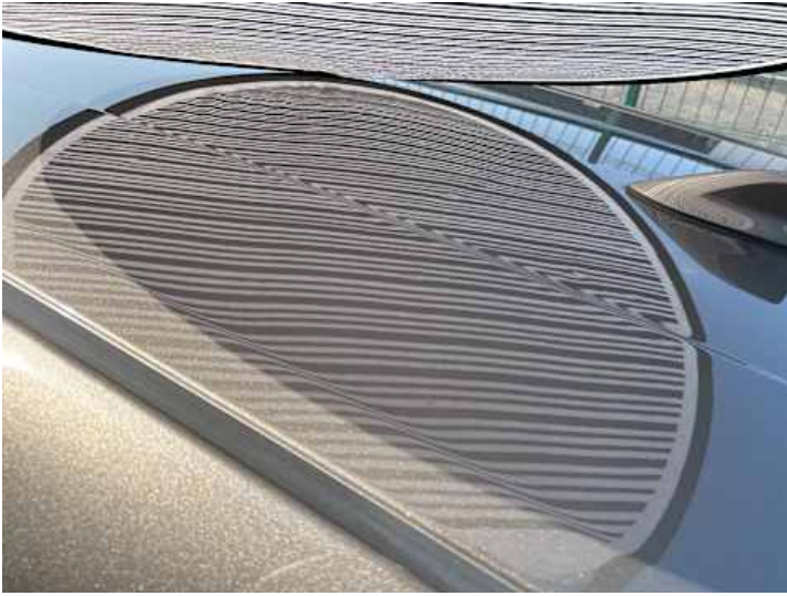
Dach (Delle, Kratzer)
