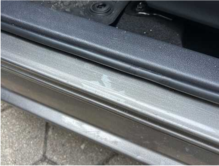
Schweller links (Kratzer, Rost)
