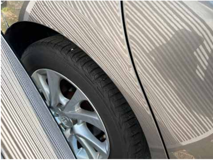
Seitenteil hinten rechts (Delle, Lackschaden)
