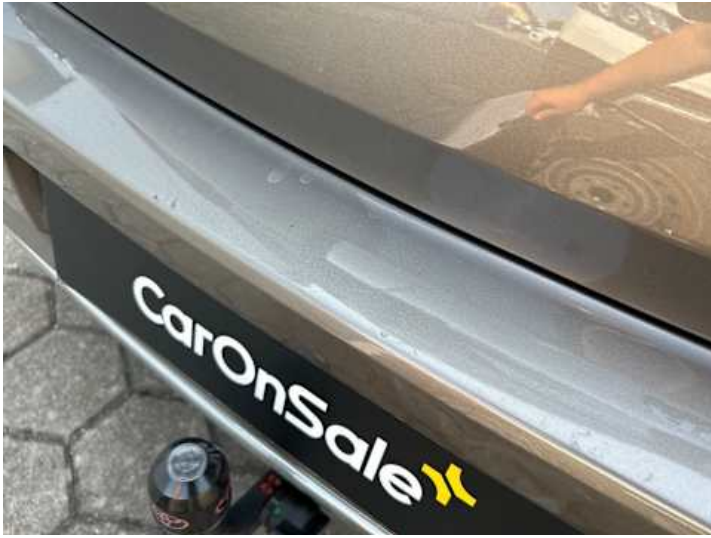
Stoßstange hinten (Kratzer, Spaltmaße ungenau)
