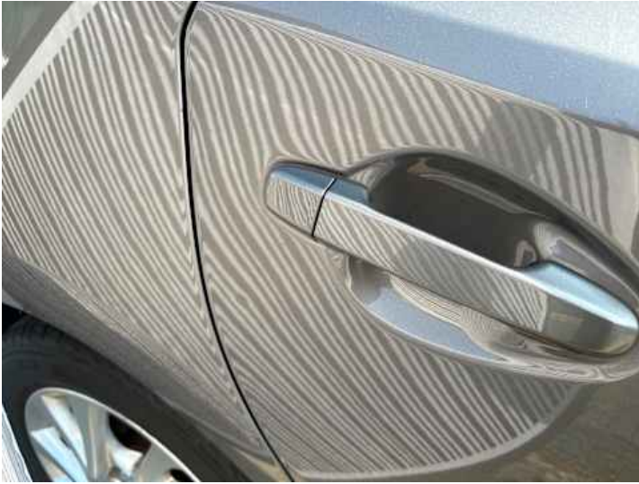
Türe hinten rechts (Delle)
