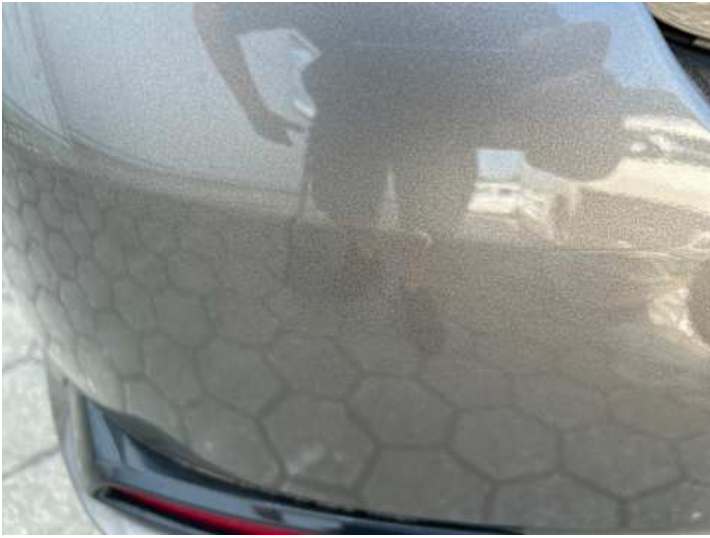
Stoßstange hinten (Kratzer, Spaltmaße ungenau)
