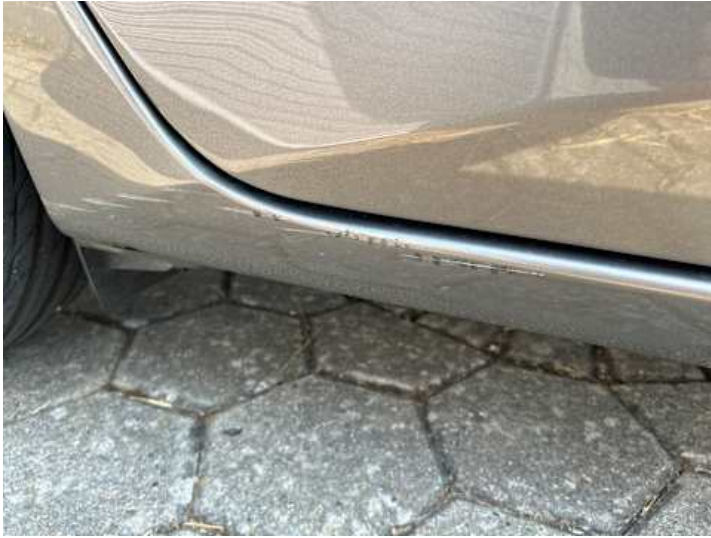
Schweller rechts (Delle, Lackschaden)
