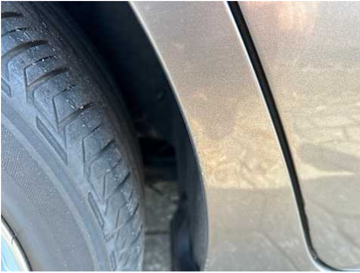
Seitenteil hinten rechts (Delle, Lackschaden)
