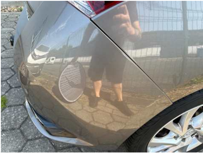
Stoßstange hinten (Kratzer, Spaltmaße ungenau)
