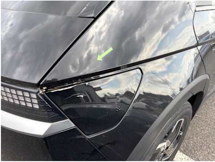
Seitenteil hinten rechts (Kratzer, Delle, Rost)
