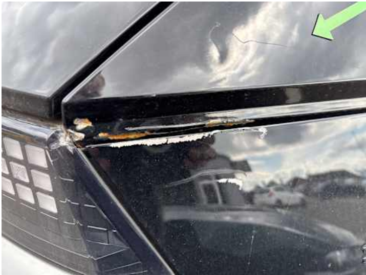
Seitenteil hinten rechts (Kratzer, Delle, Rost)
