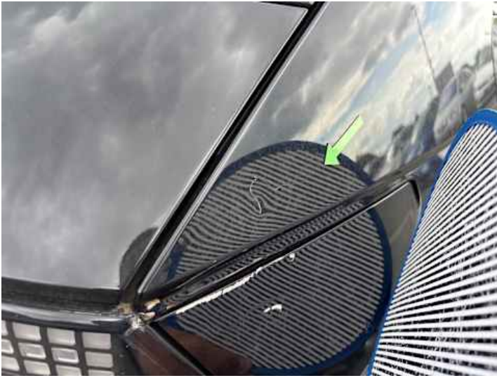
Seitenteil hinten rechts (Kratzer, Delle, Rost)
