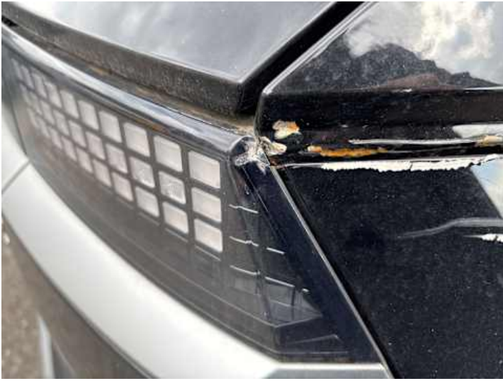
Rücklicht (rechts) (Riss/Bruch)
