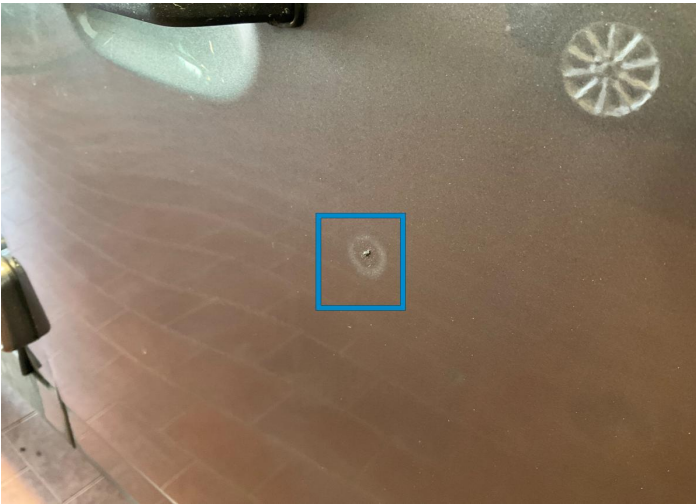
15. Tür / Vorne Rechts Lack / Chemische Schäden -
