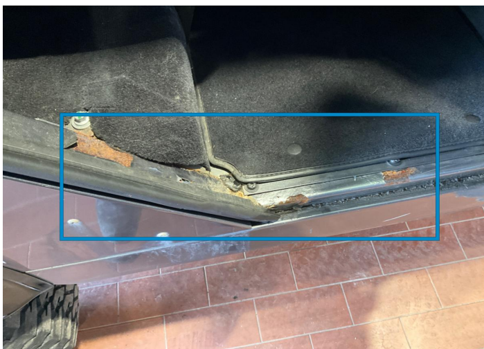
7. Säule / Hinten Rechts Lack / Chemische Schäden -
