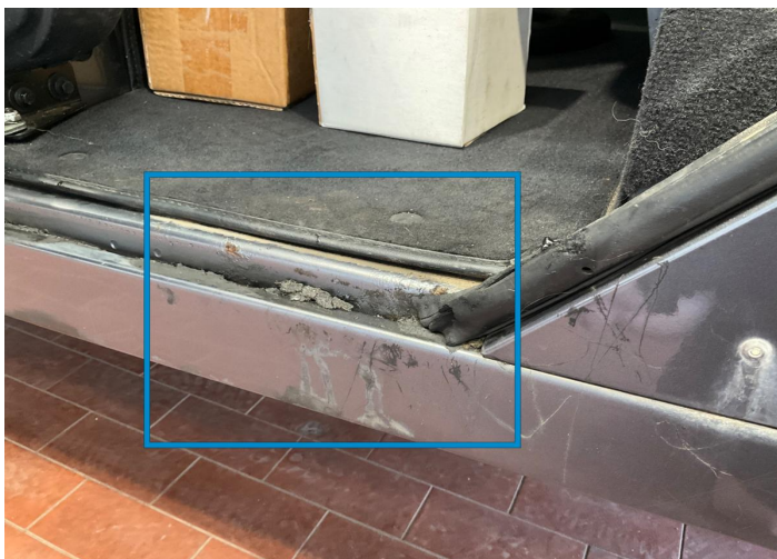
9. Einstiegsblech / MitteLinks Lack / Chemische Schäden -
