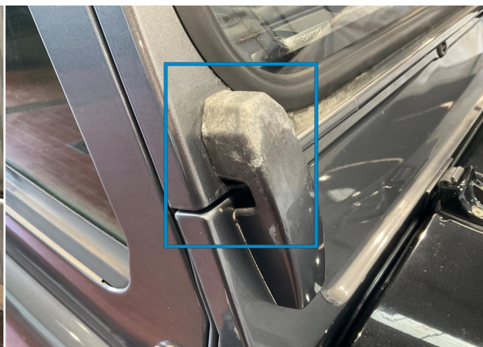
12. Säule / Vorne Rechts Lack / Chemische Schäden -
