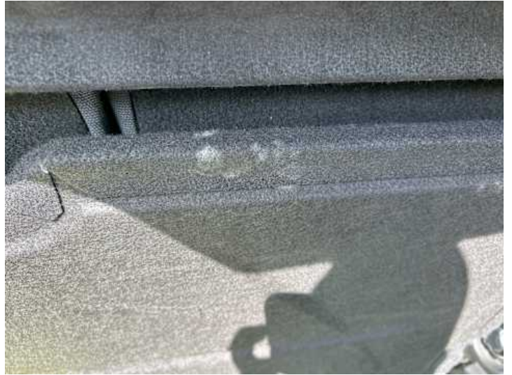
Innenraum (Kratzer, Verschleiß, Wassereintritt, Anderer Schaden): Schimmel;
