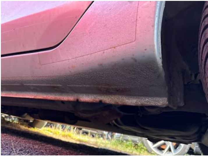
Schweller links (Rost)
