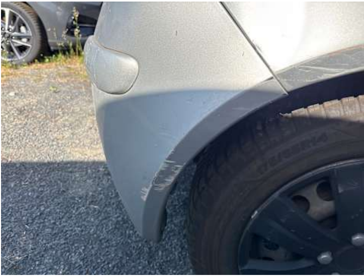
Stoßstange hinten (Lackschaden)
