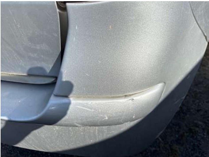
Stoßstange hinten (Riss/Bruch)
