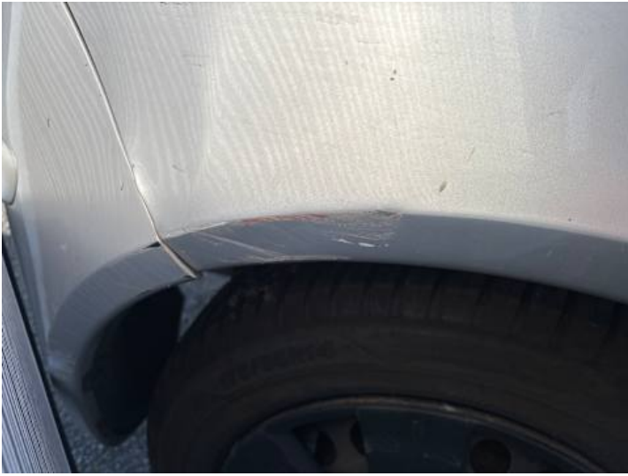
Seitenteil hinten rechts (Lackschaden, Verformung)
