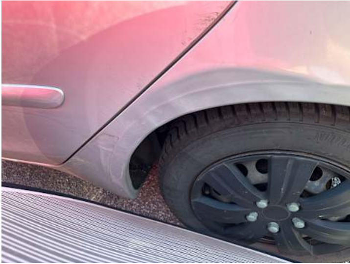
Seitenteil hinten links (Verformung)
