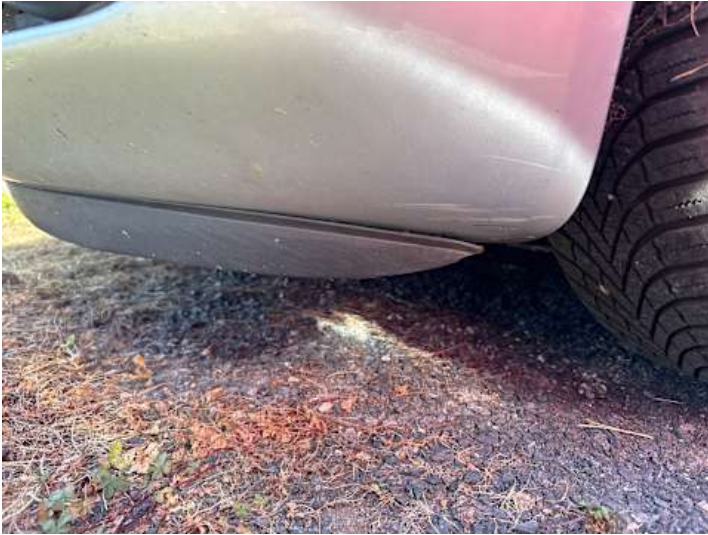
Stoßstange vorne (Lackschaden)
