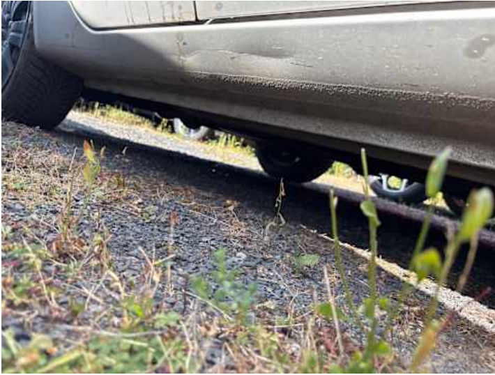
Schweller rechts (Verformung)
