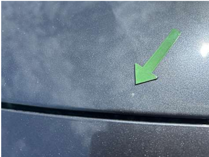
Motorhaube (Lackschaden, Steinschlag)
