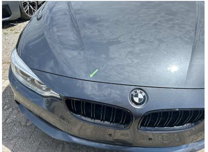
Motorhaube (Lackschaden, Steinschlag)
