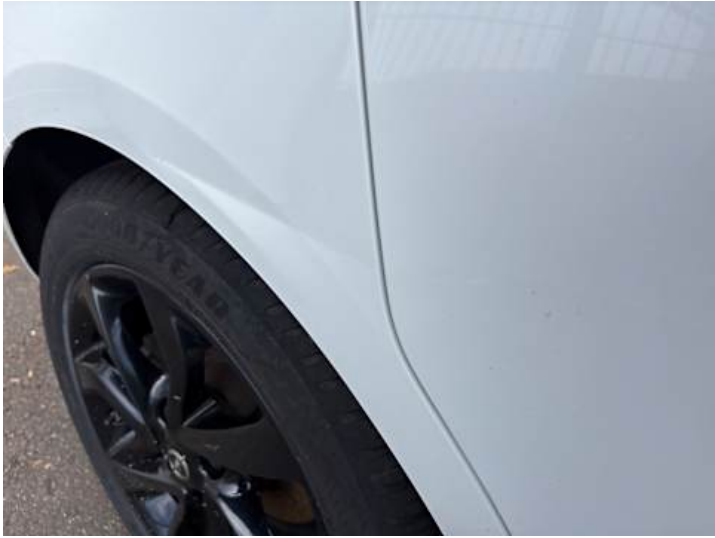
Seitenteil hinten rechts (Verformung, Lackschaden)
