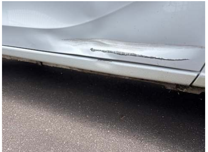
Schweller rechts (Lackschaden, Verformung)
