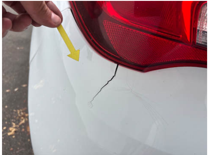
Stoßstange hinten (Riss/Bruch)
