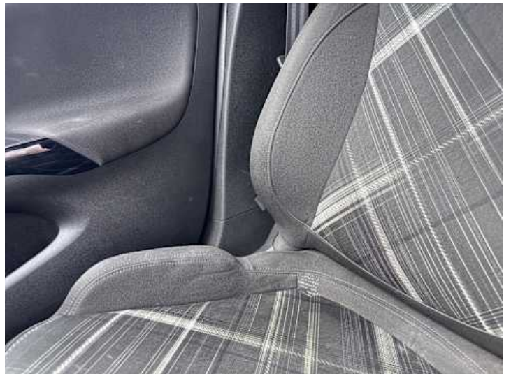
Innenraum (Verschleiß, Verschmutzung)
