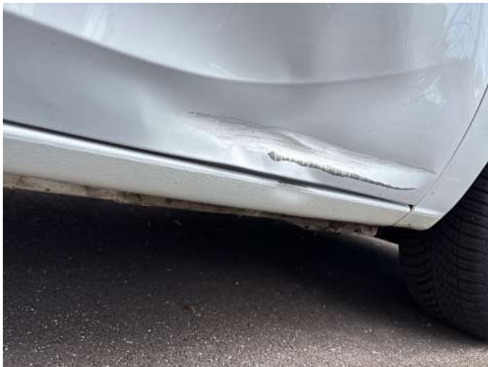
Schweller rechts (Lackschaden, Verformung)
