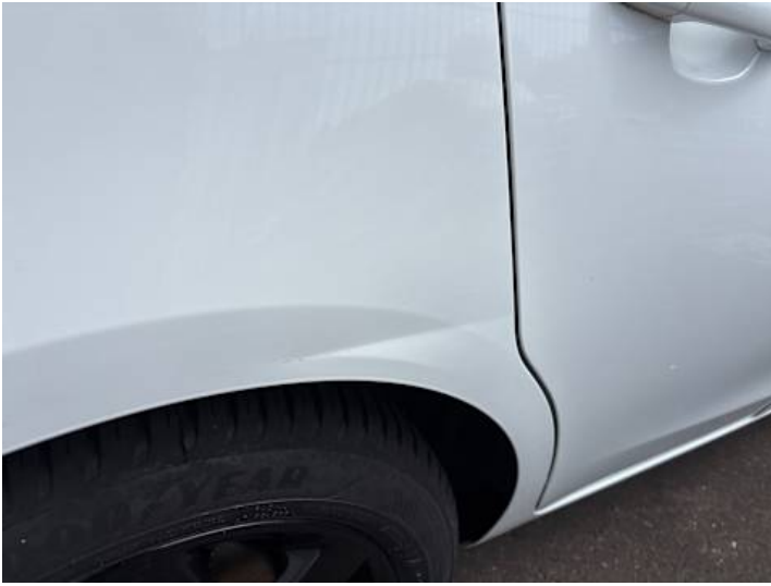
Seitenteil hinten rechts (Verformung, Lackschaden)
