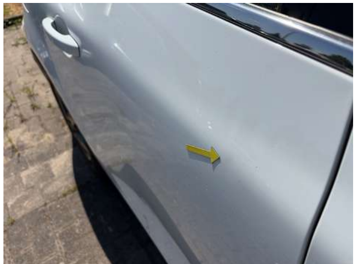
Türe hinten rechts (Delle)
