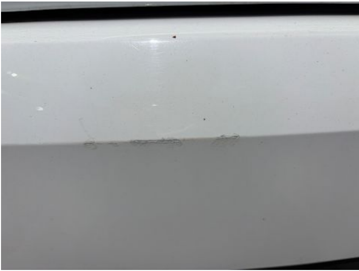
Stoßstange hinten (Lackschaden)
