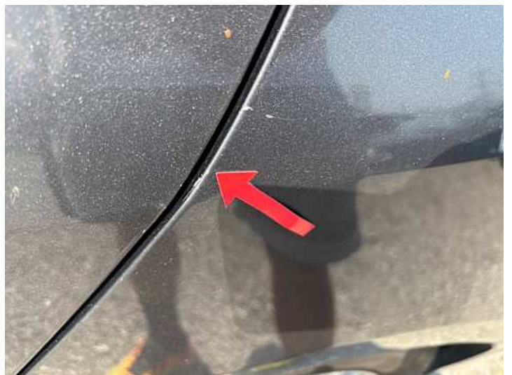
Seitenteil hinten links (Lackschaden)
