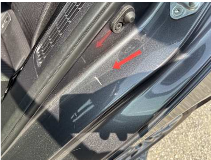
Seitenteil hinten links (Lackschaden)
