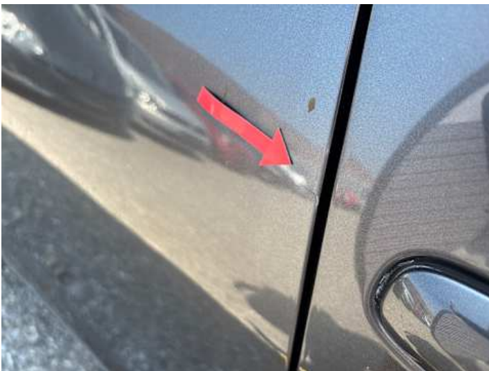
Türe hinten rechts (Kratzer)
