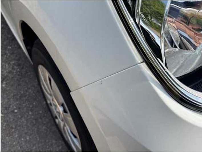
Stoßstange vorne (Spaltmaße ungenau)
